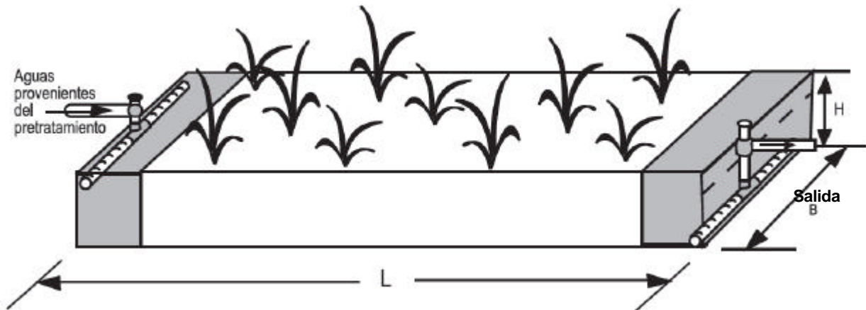
Figura 4-2.12. Principio de funcionamiento de una jardinera para tratar aguas residuales. Fuente: ISSUE, 2006.
