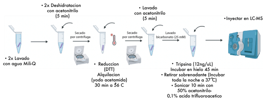
Figura 2.3. b. Esquema de pasos para la extracción y tripsinización de péptidos encontrados en las bandas escindidas del gel para su posterior análisis a través de LC-MS ( Imagen original realizada en Biorender e Illustrator ).
