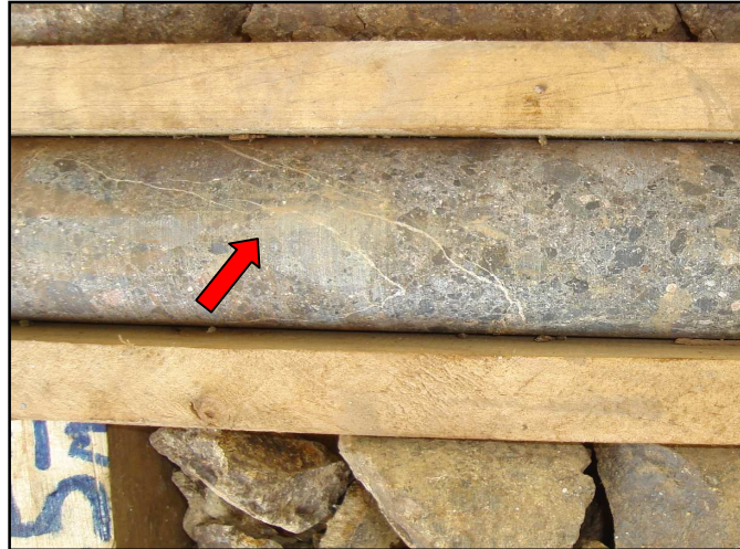
Fig. 46: Muestra de roca perforada a los 55 m de profundidad, directamente en la traza de la falla Orosi, con el fracturamiento relleno completamente de calcita (flecha roja), provocando una reducida a nula permeabilidad.
