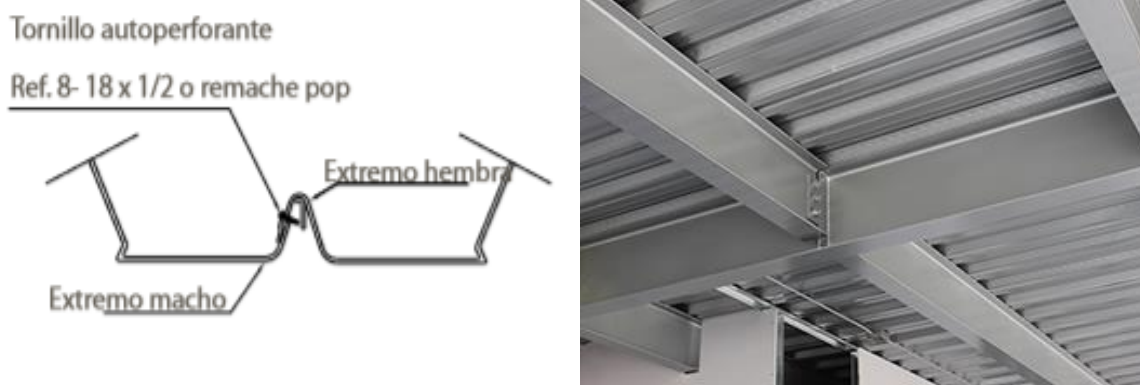
Ilustración 47. Detalle de traslape. Fuente: Manual técnico del METALDECK
