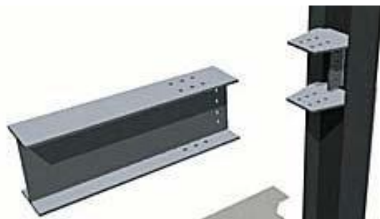
Ilustración 91. Placas soldadas a la columna y vigas apernadas. Fuente: ALACERO; MÓDULO DE UNIONES APERNADAS Y SOLDADAS; Macro Steel Project
