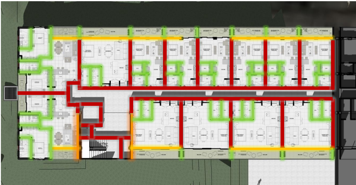
Ilustración 66. Tipos de cerramientos (ensambles) en la planta típica del Proyecto Residencial Urban Flats. Fuente: Elaboración propia
