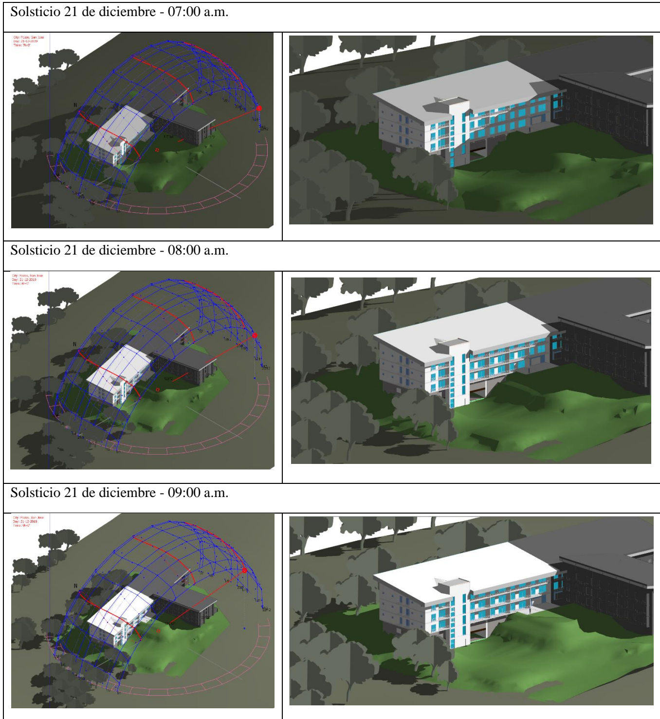
Ilustración 72. Análisis de incidencia solar por horas - Solsticio 21 de diciembre. Fuente Elaboración propia
