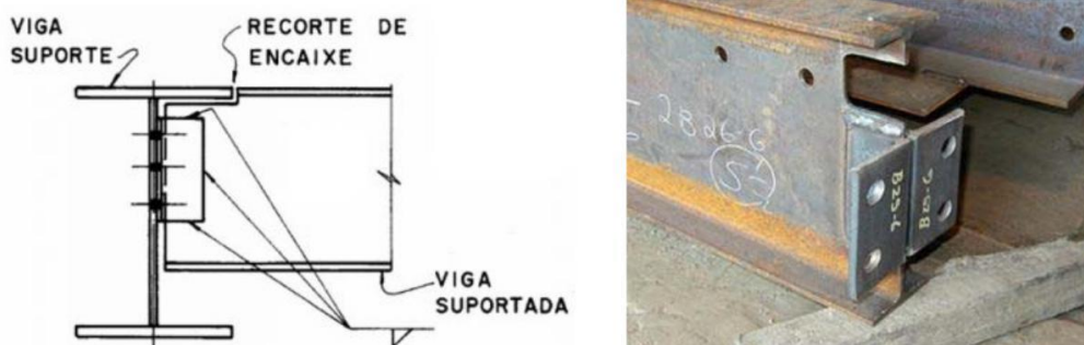
Ilustración 94. Doble ángulo soldado al alma de la viga secundaria y apernado al alma de la viga principal. Fuente: ALACERO; MÓDULO DE UNIONES APERNADAS Y SOLDADAS; Macro Steel Project 2018
