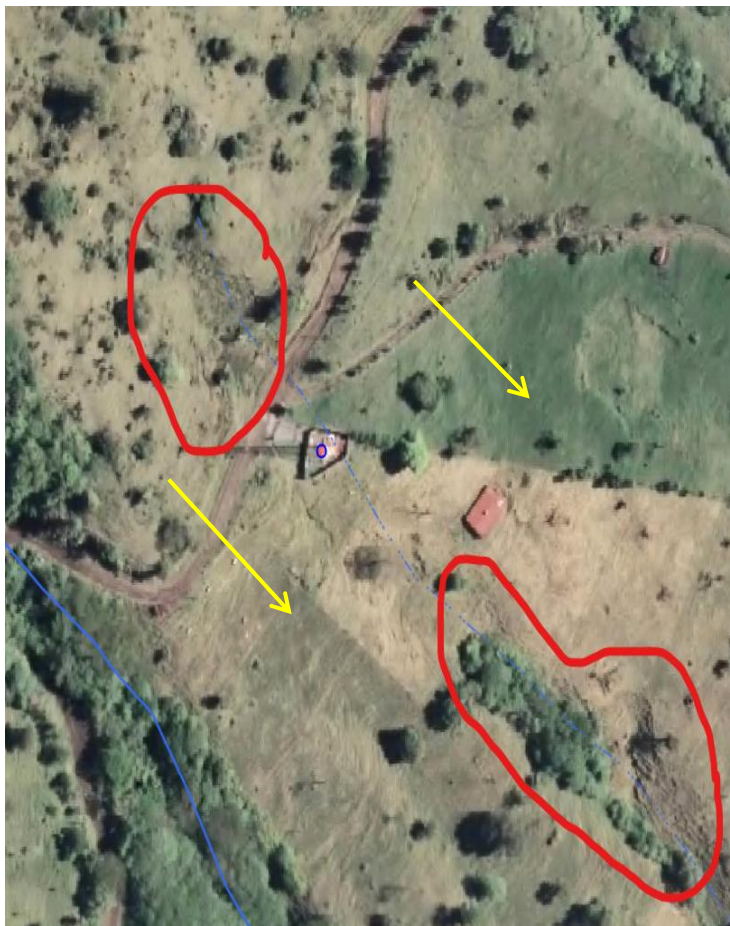
Imagen 19. En la imagen se observa señas de procesos de reptación en terrenos al norte de la Torre de telecomunicación, así como se evidencia algunas coronas de deslizamiento en el margen derecho de la depresión al Sureste de la torre, depresión que por la topografía del terreno parece afectar en dirección al sector en donde se ubica la torre de telecomunicación, dicha depresión se puede estar activando en el momento de haber precipitaciones. Con una dirección de la pendiente hacia el sureste en el caso de un deslizamiento, la torre podría verse afectada a futuro, ya que no se observa una cobertura vegetal que funcione como soporte o que puede colaborar en la estabilidad de los terrenos alrededor de la torre
