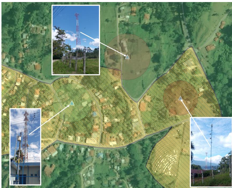
Imagen 31: Esta imagen muestra la ubicación de las torres de telecomunicación en el poblado de Tres Equis, con la mancha de cuadrante urbano, en la que vemos en achurado las áreas con restricciones dentro del cuadrante urbano y en verde las áreas con restricciones, en esta área se observa una torre. (fuente: Ortofoto 2017, cuadrantes urbanos SNIT)
