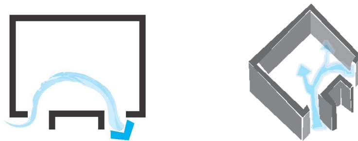
Imagen 3-2.13 Diagrama de ventilación unilateral con obstáculos en la fachada. Fuente: ProDUS-UCR, 2010.
