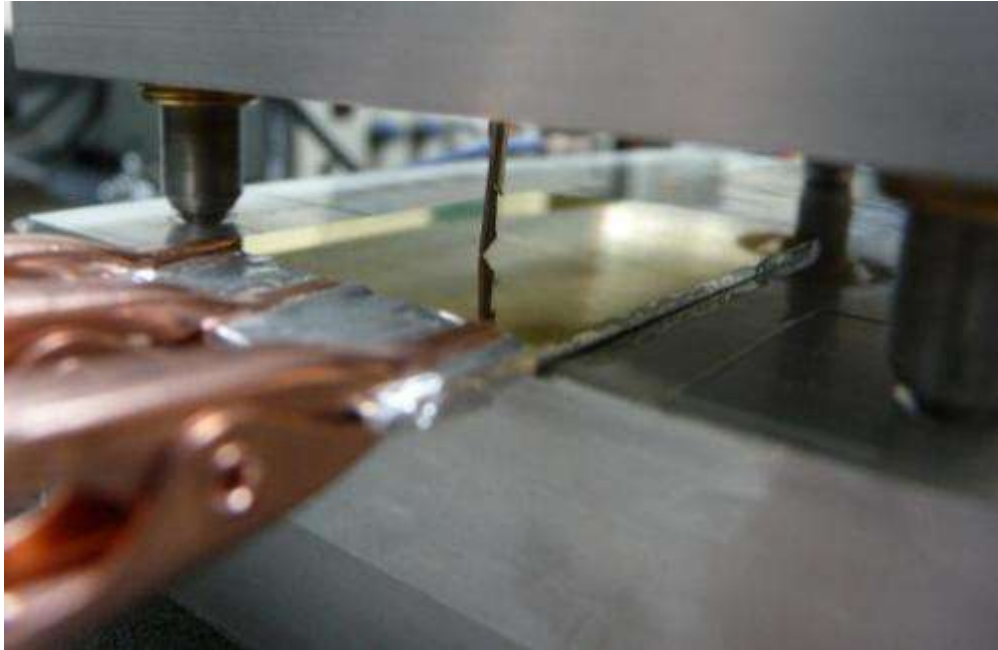
Figura 4.35: Acercamiento punta de Tungsteno
