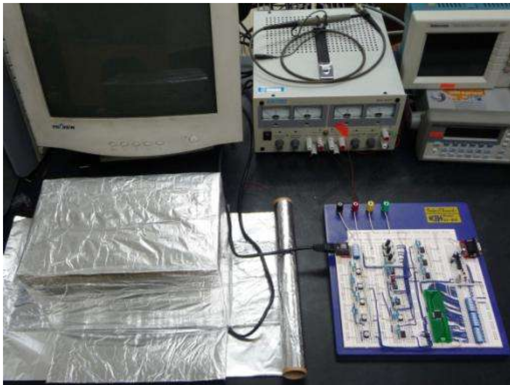
Figura 4.33: Jaula de Faraday del sistema de microscopía
