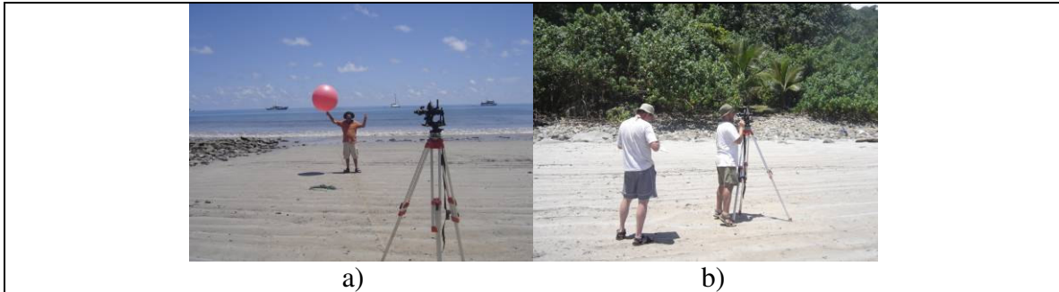
Foto 2. a) Lanzamiento de globos piloto desde Bahía Chatham, 5^{\circ} 32' 52.2'' N, 87^{\circ} 02' 32.1'' W, a nivel del mar. b) Seguimiento del globo por medio de un teodolito meteorológico. Mediciones hechas el 07/04/2008. Fotografías por Eric Alfaro.
