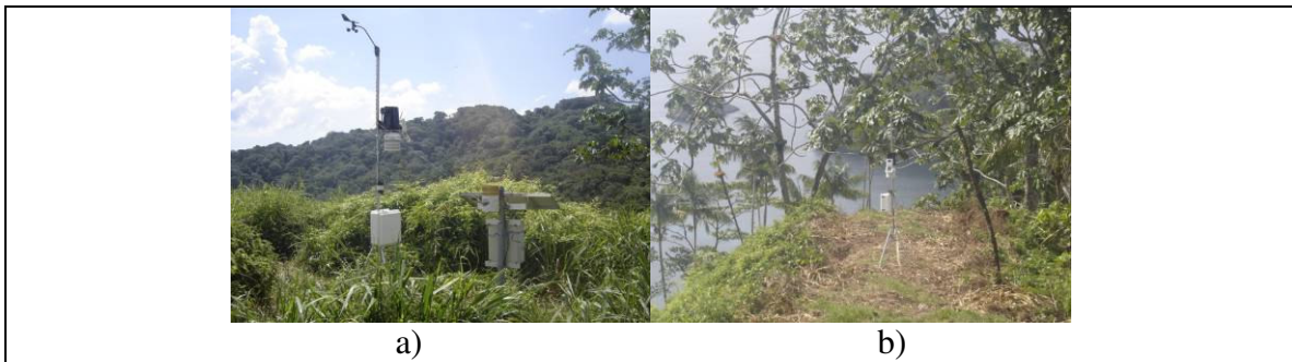
Foto 1. Estaciones automáticas marca Davis, tipo Vantage Pro Plus. La primera ubicada en a) Bahía Chatham con coordenadas: 5° 32' 50.82'' N, 87° 02' 43.26'' W, 142 msnm y la segunda en b) Bahía Wafer con coordenadas: 5° 32' 23.5'' N, 87° 03' 25.9'' W, 132 msnm. Fotografías por Eric Alfaro.
