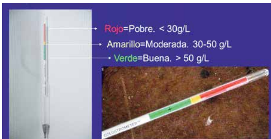
Figura 1. Calostrómetro para determinar la concentración de inmunoglobulinas totales en calostro de vacas lecheras.
