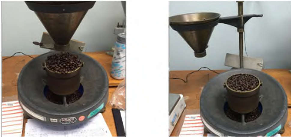
Figura 2.7. Densímetro, equipo para medición de densidad aparente
