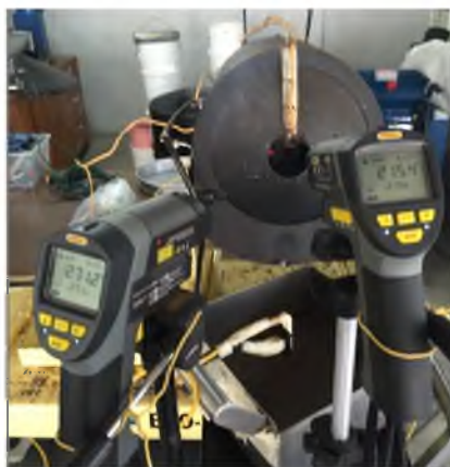
Figura 2.3. Medidor infrarrojo para registro de temperatura de masa de granos y pared interna del cilindro.
