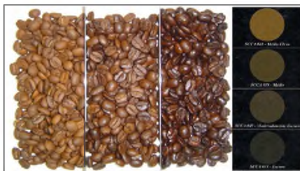
Figura 2.6. Tabla Agtron sobre grados de torrefacción.
