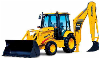
“Back Hoe” (Retroexcavador)
