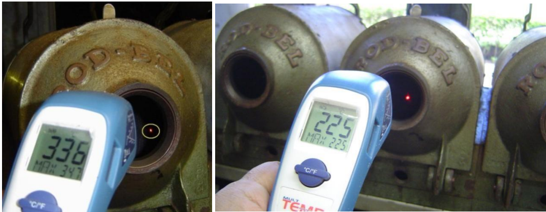
Figura 1 - Medição da temperatura na parede interna do torrador e da massa dos grãos de café.
