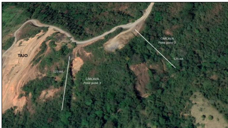
Figura 47. Cárcavas generadas por lavado superficial con entradas de caminos para camiones ubicadas dentro del Tajo en Cañas de Tabarcia; la tercer formación está ubicada 340 metros al noroeste de Pone pone 2.
