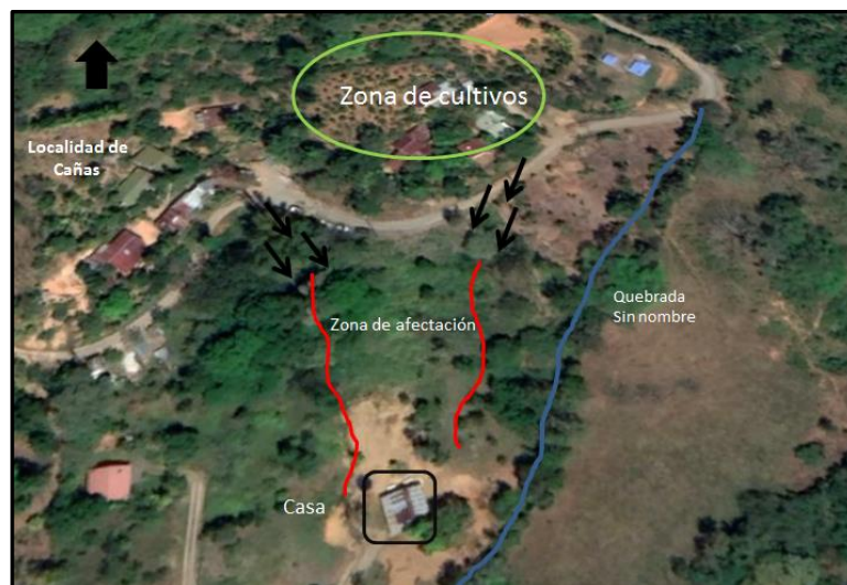
Figura 29.- Croquis de la unidad habitacional con afectación por desvío de aguas intencional. (Doña L. entrevista personal. junio 2019). Las flechas negras representan la dirección de flujo de agua y las líneas rojas las zonas de erosión. Lat. 9.857978°; Long. -84.225415°.
