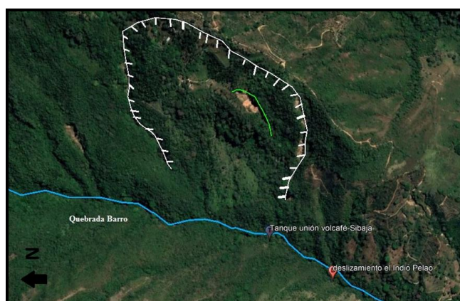
Figura 39.- Corona de deslizamiento activa nombrada Momoto hacia la parte NE de los SH i de la ASADA de Tabarcia de Mora (Sistema Volcafé-Sibaja). Al sur se localiza el deslizamiento El Indio Pelao. La línea verde representa un área de basculamiento hacia la parte central de este deslizamiento. Google Earth (2019).
