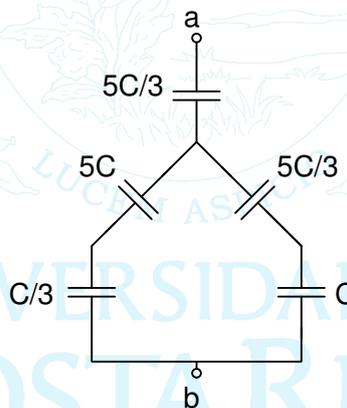
Seguidamente se reducen los capacitores en serie de cada rama en paralelo (2.5pts).
