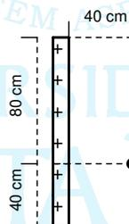
Este es el caso de un alambre de longitud L con una carga de prueba a una distancia x que no coincide con su eje de simetría. Por lo tanto tendríamos que resolver las dos componentes de la fuerza (10 pts).
