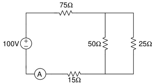
La resistencia del circuito equivalente estaría dada por (5pts):
