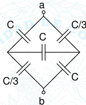
Para reducir este circuito se debe realizar una transformación delta a estrella de la siguiente forma (5pts):
