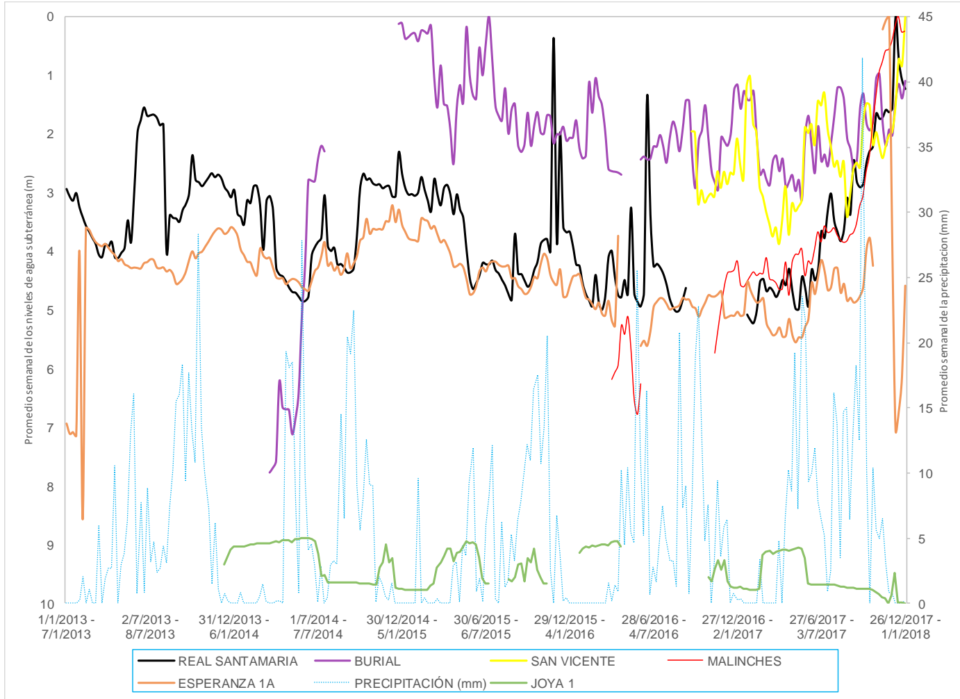
Figura 79. Tendencias de los niveles del agua subterránea en pozos que captan los acuíferos Colima Superior e Inferior
