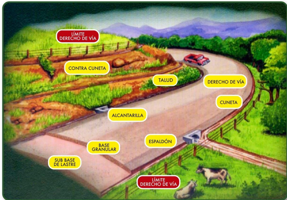
Figura 1. Calle rural Fuente: GTZ, 1998.
