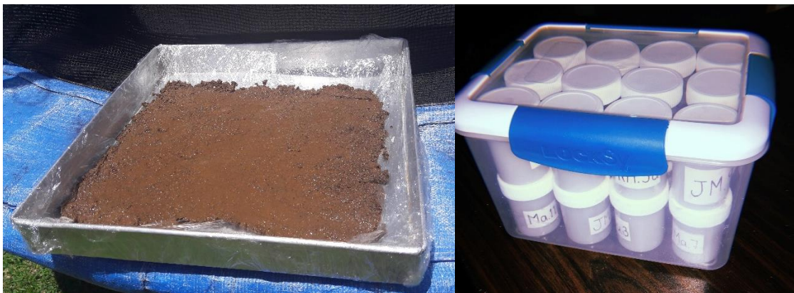
Figura 12. Preparación de las muestras de sedimento fluvial. Imagen izquierda muestra el secado de las muestras al sol, la imagen derecha muestra el almacenamiento de las muestras de sedimento fluvial para enviarlas al laboratorio.
