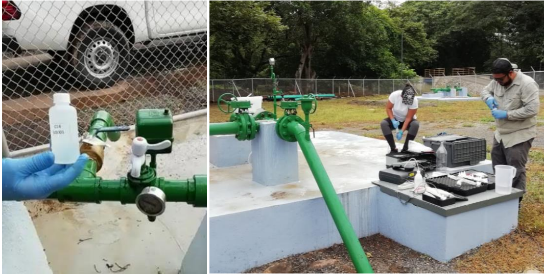
Figura 11. Recolección de muestras de agua subterránea. La imagen izquierda muestra el envase y etiquetado de las muestras, la imagen derecha muestra la filtración de las muestras y medición de parámetros de campo.
