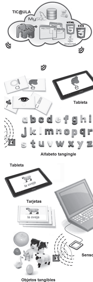
Figura 3. TIC@ULA repositorio virtual de objetos de aprendizaje en la web. KITERACY es un kit de objetos tangibles que utilizan un sistema de identificación por radio frecuencia (RFID)
