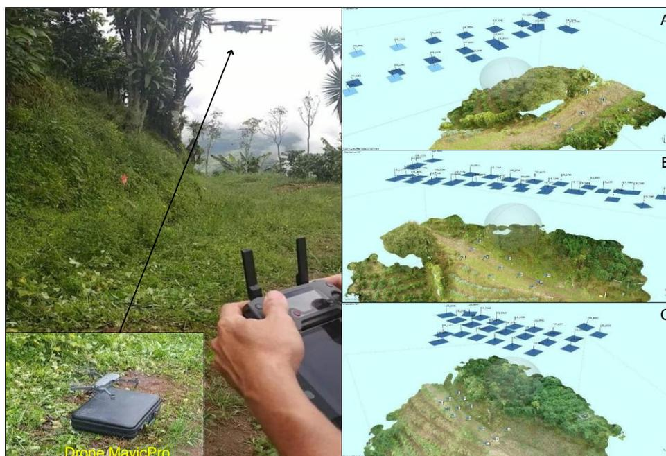
Figura 10. Vista aérea de ortomosaico, con plan de vuelo a 20 m y colocación de puntos de control en caminos. A la izquierda el dron modelo MavicPro, parcela 1 (A), parcela 2 (B) y parcela 3 (C), cuenca alta, Llano Brenes, San Ramón, Alajuela 2018.
