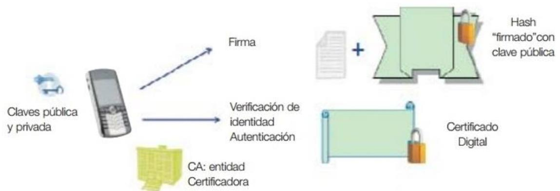
*Figura 5 Diagrama de firma digital usando tarjeta SIM. Fuente: (Alcaraz 2019)*
