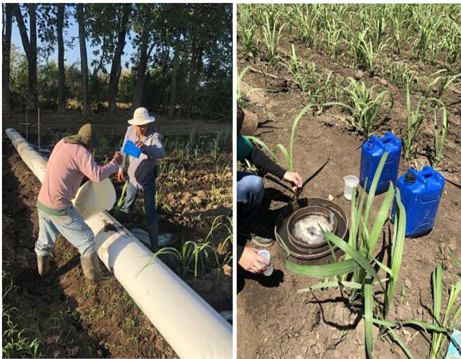
A 32. Aforo del riego para cada surco. A 33. Prueba de Infiltración.
