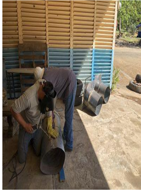
A 26. Siembra de Var, LAICA 12 339. A 27. Construcción compuertas metálicas.
