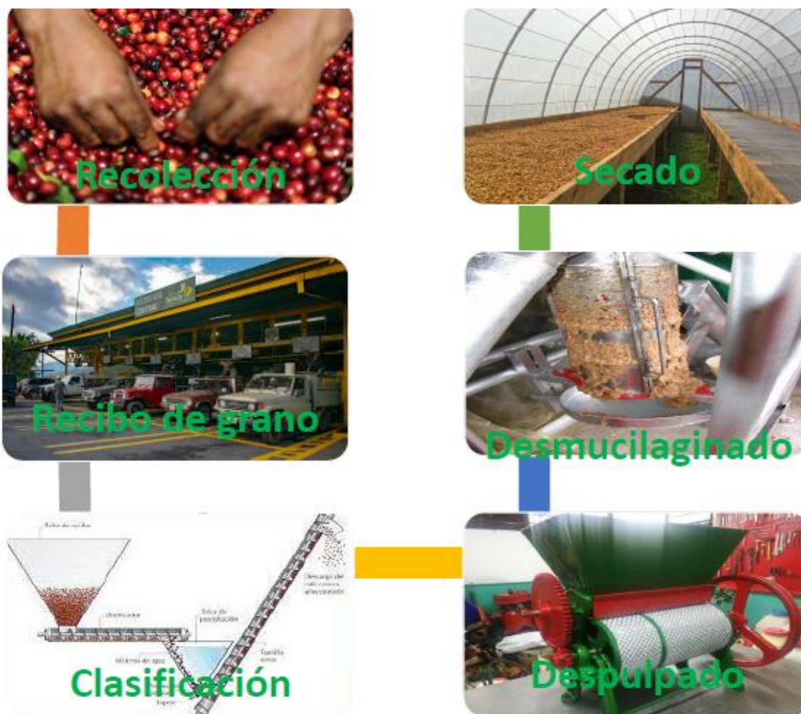
Figura 2: Esquema beneficiado de café. Proceso húmedo (elaboración propia, imágenes tomadas de Internet)
