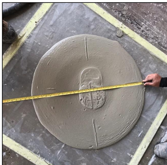
Figura 38. Prueba de flujo del concreto CRC autocompactable.
