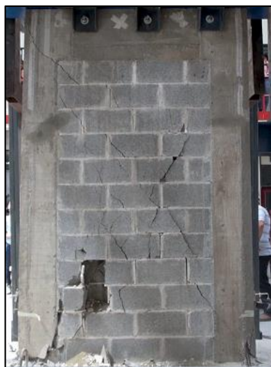
Figura 62. Estado final del Muro RA1.5.
