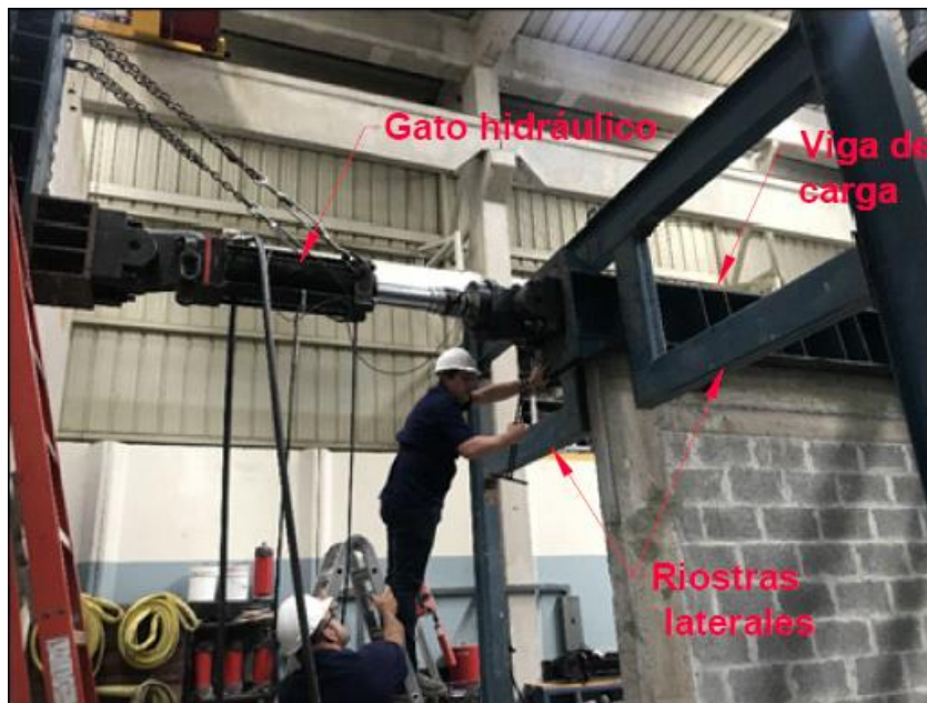
Figura 46. Anclaje de gato hidráulico a viga de carga.
