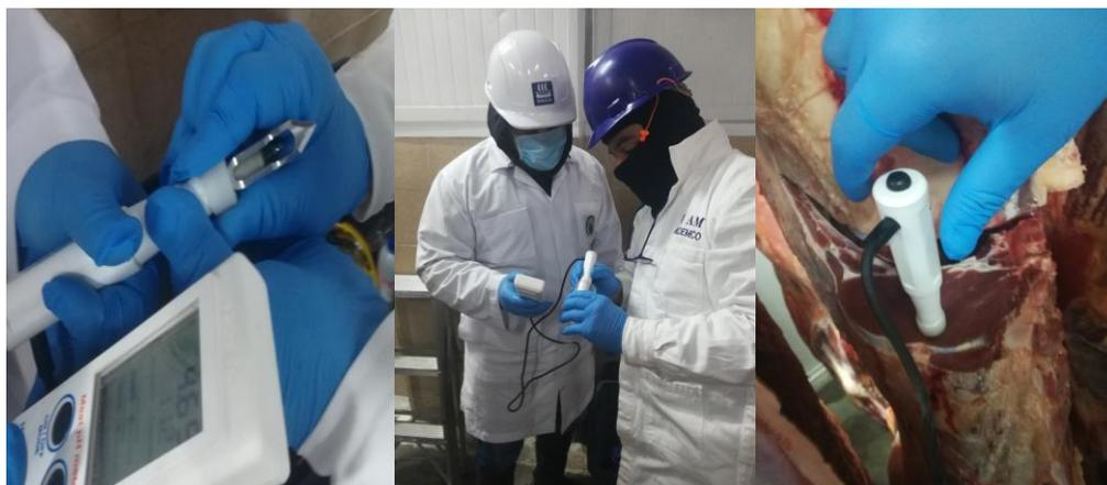
**Figura 35.** Punta de acero inoxidable, calibración y método de utilización del pH-metro para la medición de pH y temperatura a las 24 horas post mortem.
