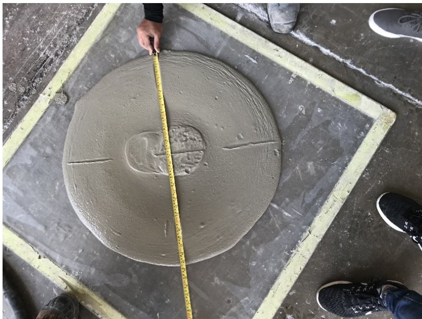
Figura 39. Prueba de fluidez del concreto de relleno.
