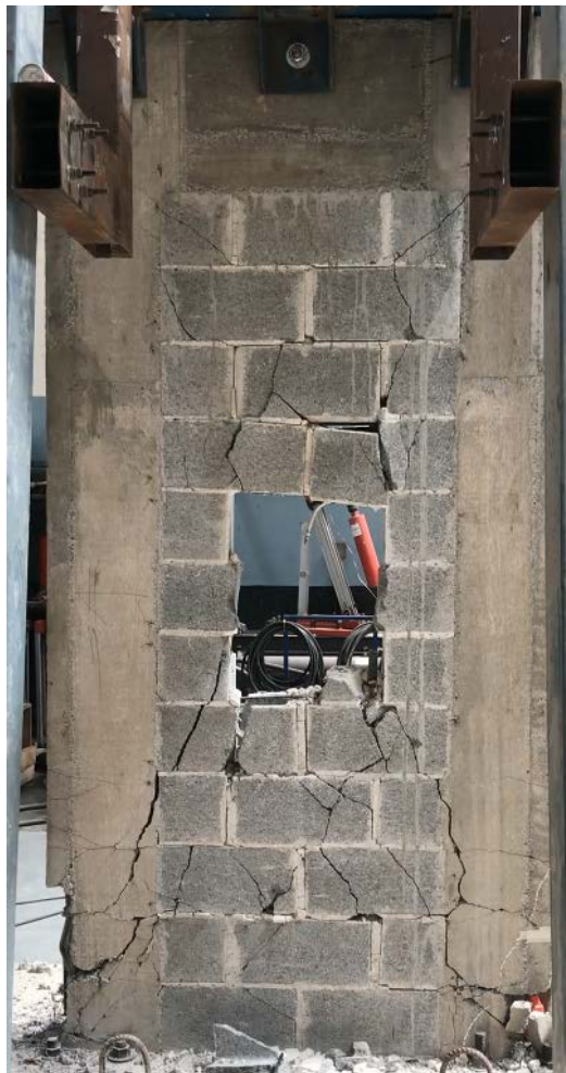
Figura 75. Condición final del Muro E.
