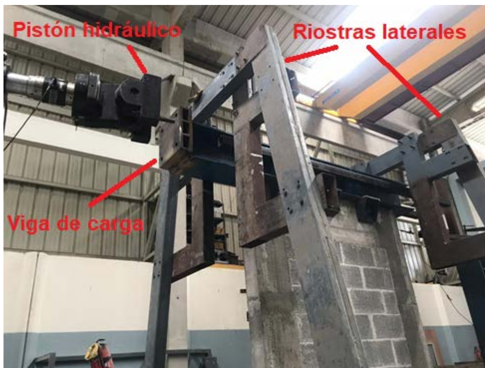
Figura 50. Riostras laterales, pistón hidráulico y viga de carga sobre muro de mampostería.
