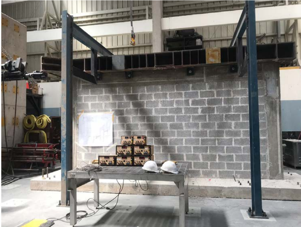
Figura 49. Montaje del muro en el laboratorio de fuerza.
