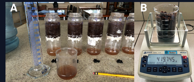
Figura 4. A. Cuantificación de volúmenes drenados por muestras de fibra de coco evaluadas mediante frascos de volumen conocido B. Mediciones de masa de frascos de vidrio rellenos de fibra de coco.
