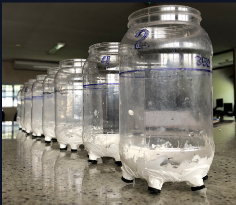
Figura 1. Frascos de volumen conocido confeccionados con una relación 1:1. V= 350mL.
