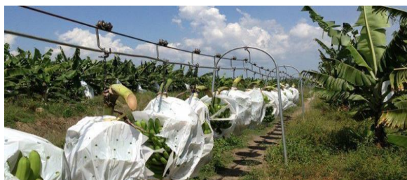
Figura 2. Ejemplo de cable vía para transporte de bananos. Fuente: Mendoza (2018).
