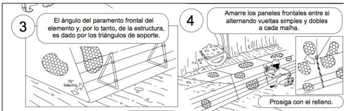
Figura 87. Paso 3 y 4 para instalación del sistema Terramesh Verde.
