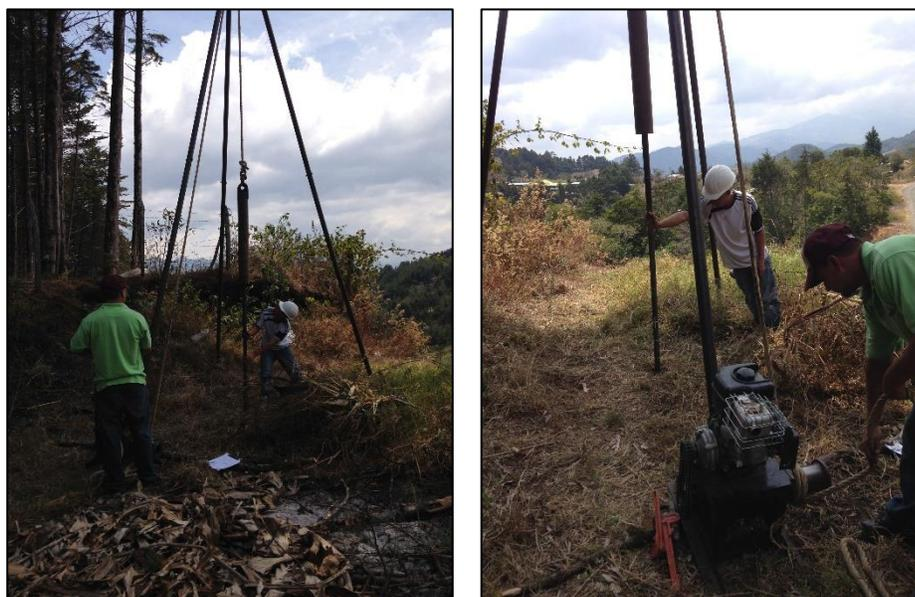
Figura 12. Ensayo de penetración normal en la corona del talud.
