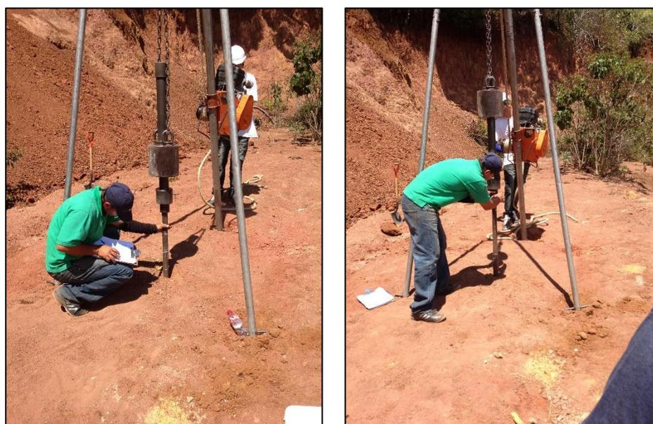
Figura 13. Ensayo de penetración normal en el cuerpo del talud.
