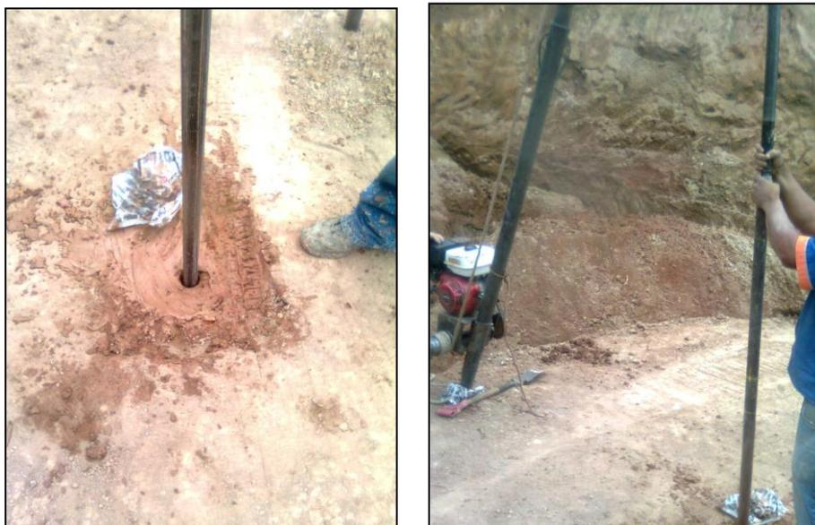
Figura 14. Ensayo de penetración normal en la base del talud.
