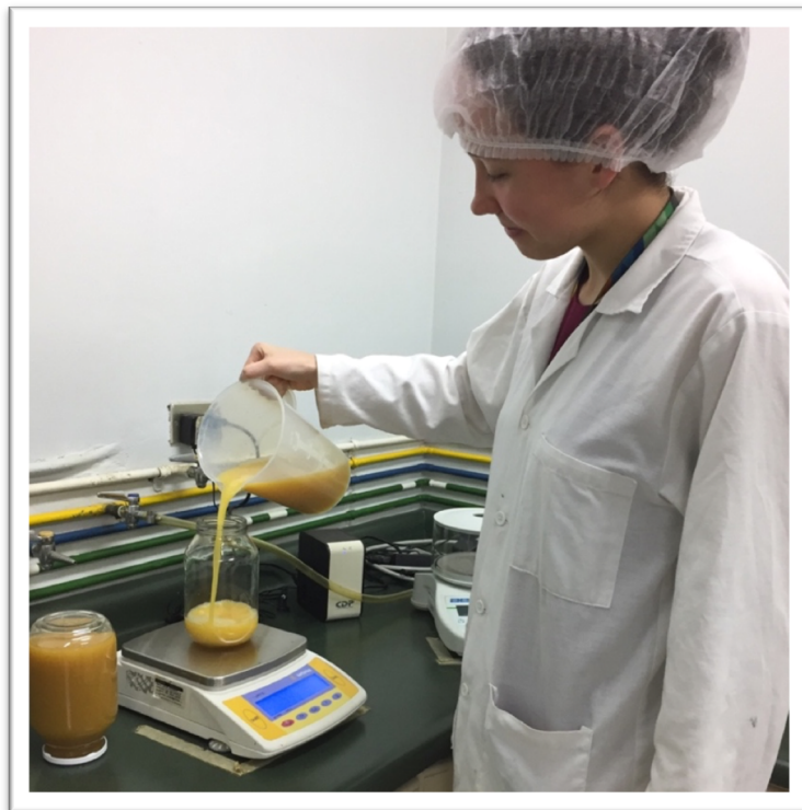
Figura 7. Preparación de jugos de planta piloto mediante el proceso de llenado en caliente e inversión del envase.
