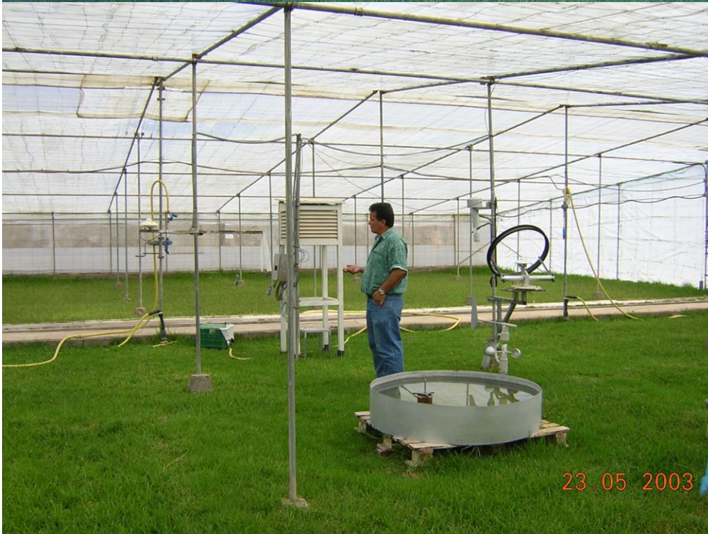
Estación meteorológica y tanque evaporímetro clase A para la determinación de la evapotranspiración del cultivo de referencia, bajo invernadero.
