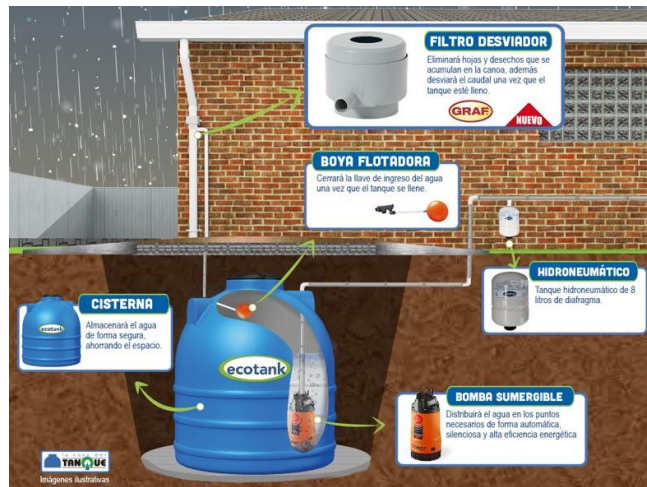
Sistema de recolección de agua de lluvia Subterráneo.
