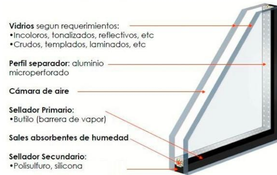
Detalle de paneles de vidrio de doble capa.
