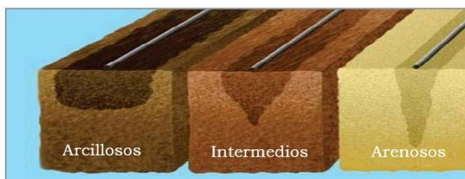
**Figura 2.** Comportamiento de la zona húmeda según el tipo de suelo: arcilloso (heavy), intermedios (medium) y arenosos (light) (Ahmad y Ajaz, 2013).
