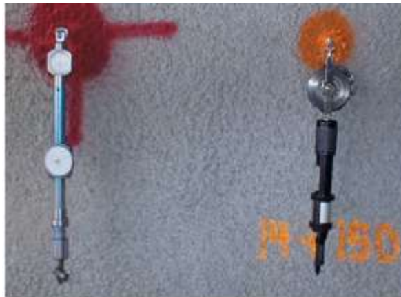
Figura 3.95. Equipos de medición a la izquierda el Distómetro y a la derecha la Cinta Invar
