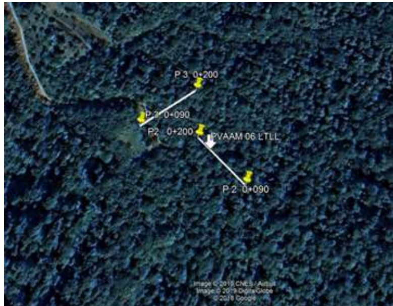
Figura 4.163. Trazado de los dos perfiles de refracción sísmica y resistividad eléctrica realizados sobre el área del portal de salida del túnel
