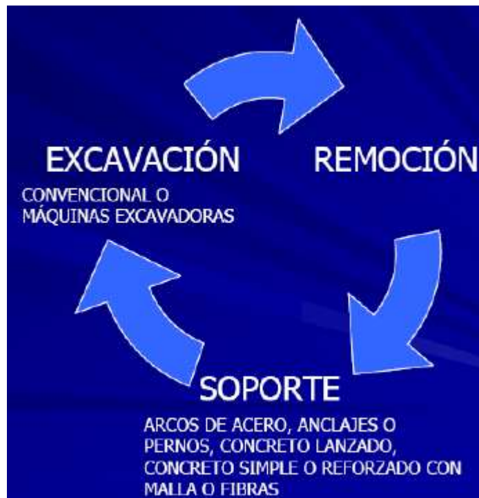
Figura 3.77. Proceso cíclico del método convencional
