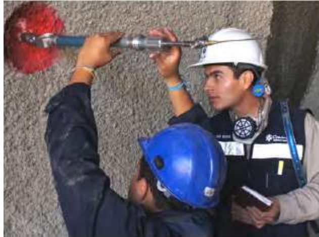
Figura 3.94. Realización de una medición de convergencia por medio de una cinta invar
