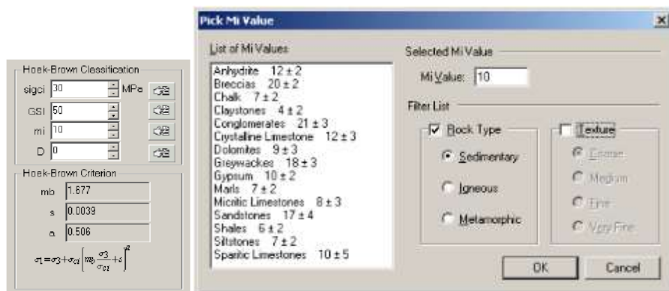
Figura 3.72. Estimación de los datos de entrada del criterio generalizado de Hoek & Brown mediante el software RocData 3.0
