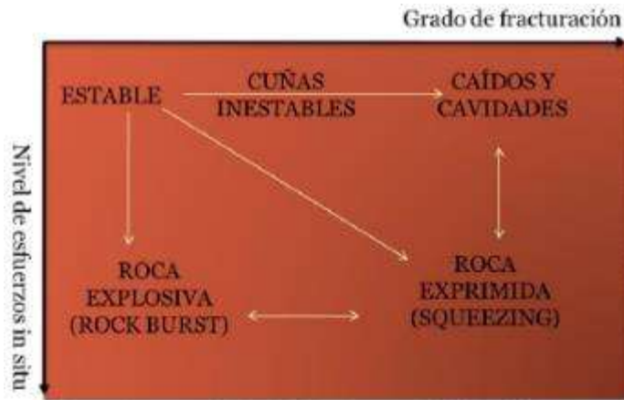
Figura 3.85. Definición general del comportamiento de la masa rocosa en función del análisis de esfuerzos y las condiciones geomecánicas del terreno
