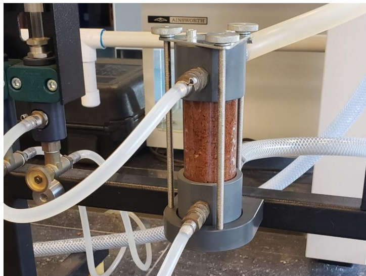
Figura 41. Determinación de permeabilidad en muestras de relleno sanitario
