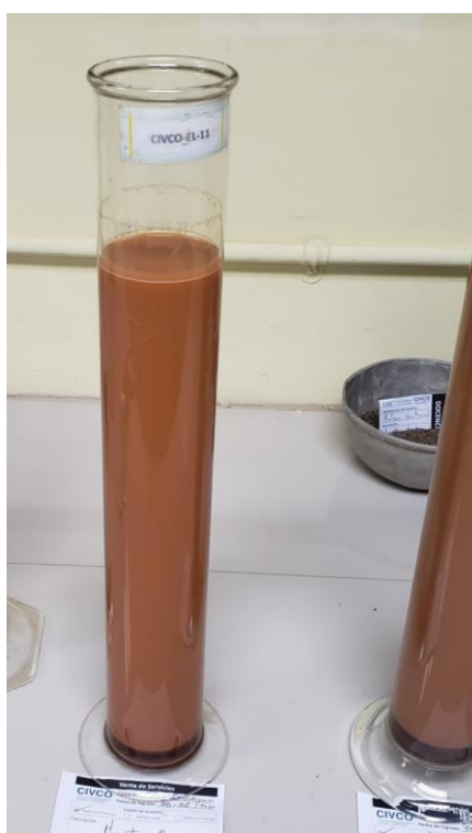
Figura 34. Probeta de sedimentación utilizada en el análisis granulométrico por vía húmeda.
