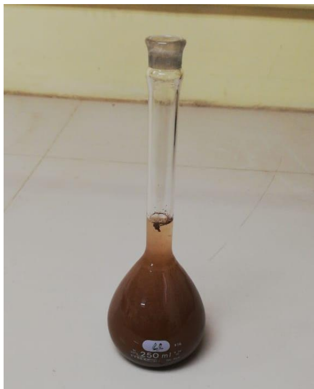
Figura 40. Picnómetro con muestra de suelo del relleno sanitario
