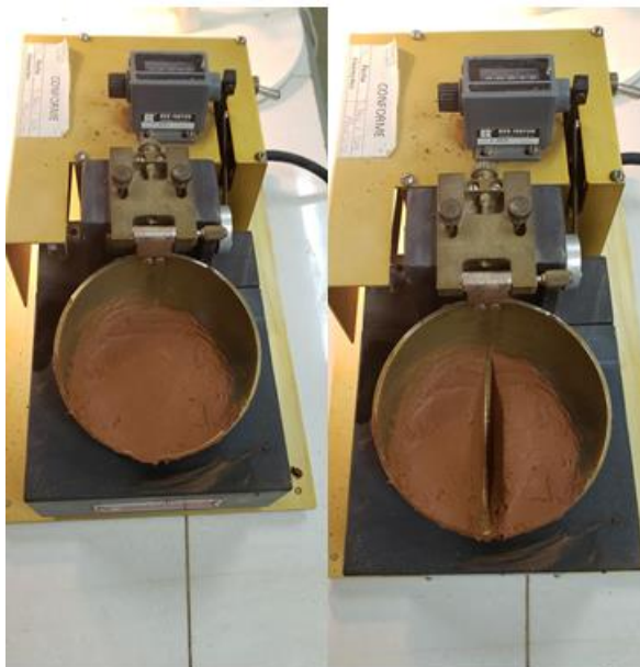
Figura 75. Determinación del límite líquido de suelos de cobertura.
