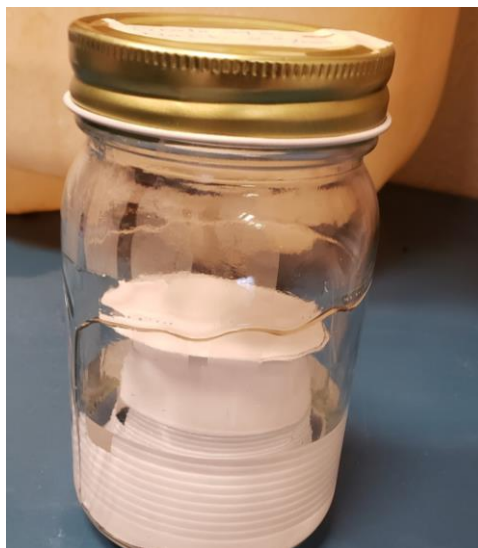
Figura 15. Proceso de calibración de papel de filtro
