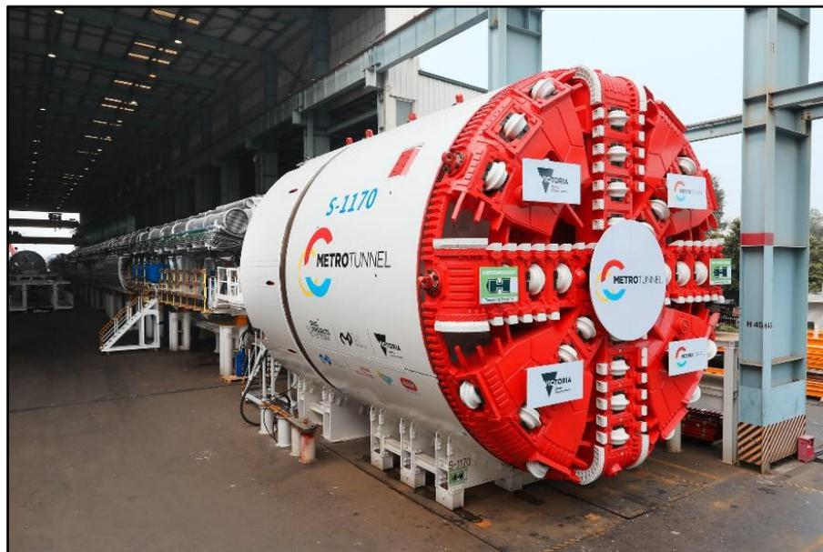
Figura 3.11. Máquina tuneladora con escudo de equilibrio de lodos (Slurry TBM)
