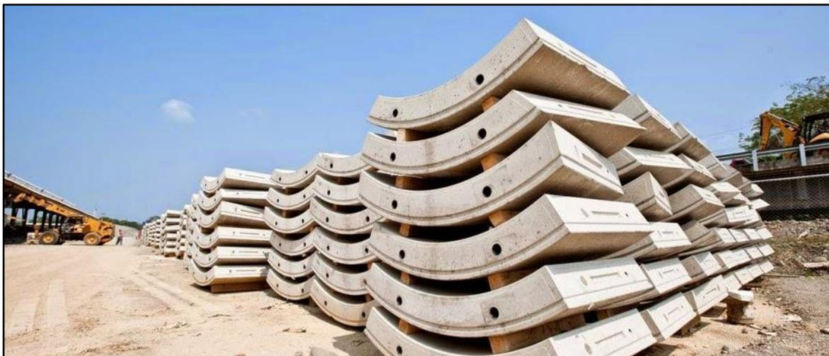
*Figura 3.20. Dovelas de concreto prefabricado*
