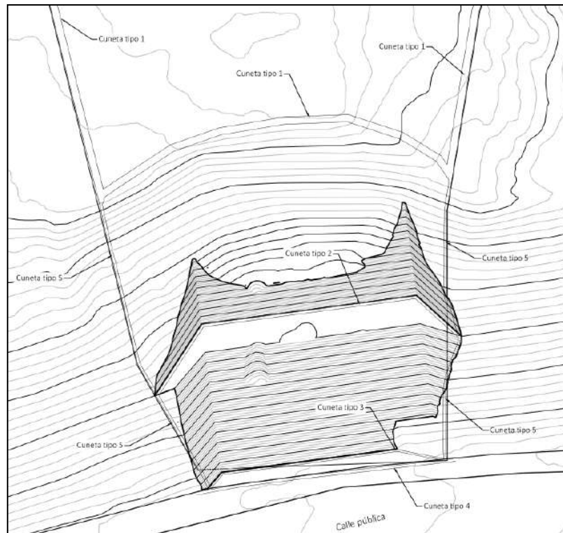
Figura 2.38. Sistema colector de aguas de escorrentía superficial
