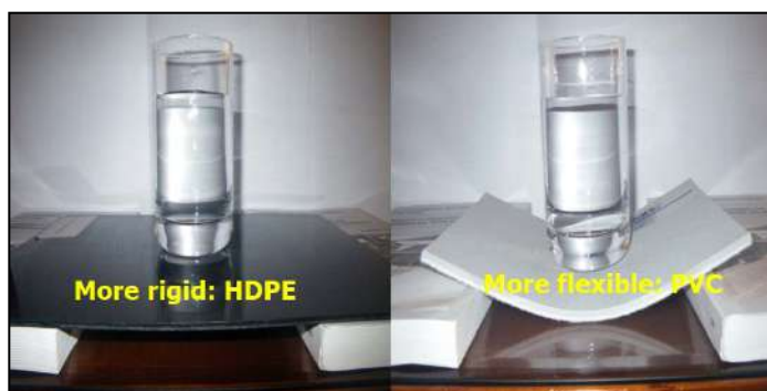
Figura 4.33. Comparación entre geomembrana HDPE (izquierda) y geomembrana PVC (derecha)
