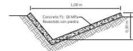
SECCIÓN DE LA CUNETA TIPO1 ESCALA 1:20
