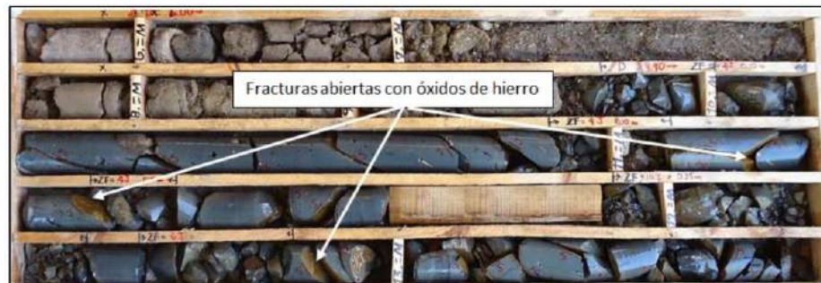
Figura 4.24. Patrón de fracturamiento abierto en las cercanías de la falla F-20 Fuente: ICE, 2018
