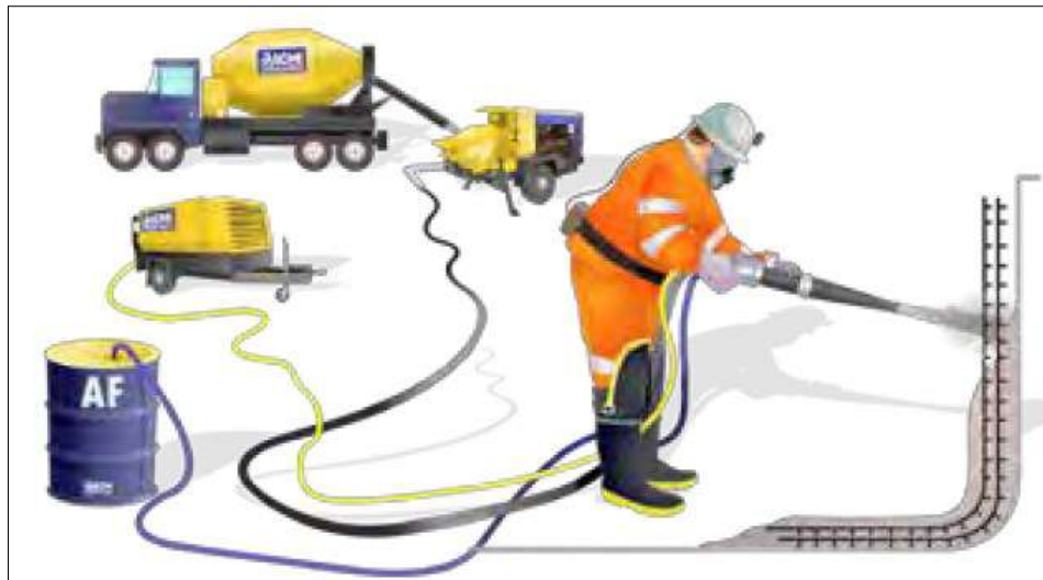
Figura 2.42. Equipos – concreto lanzado vía húmeda
