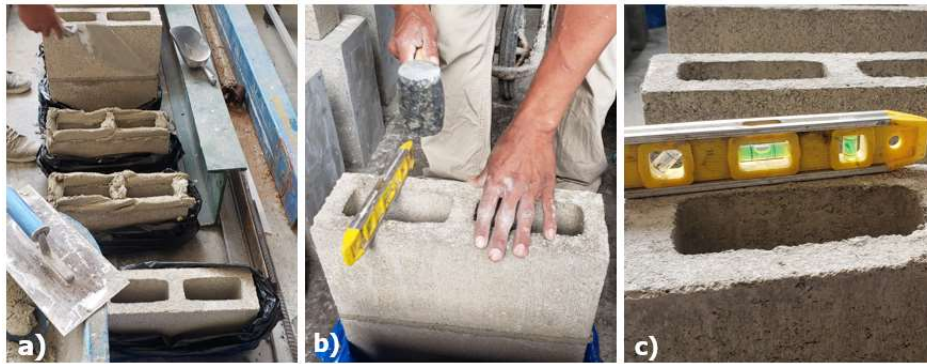
Figura 14. Confección de los prismas de mampostería: a) Colocación del mortero, b) Fijación del segundo bloque y c) Nivelación correcta del prisma terminado.
