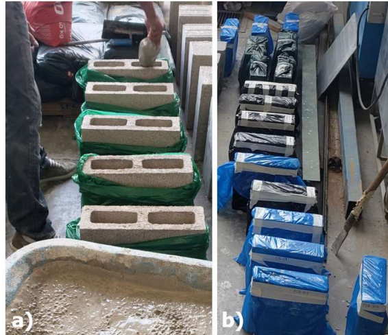
Figura 15. Procedimiento final de la confección de los prismas de mampostería: a) Vertido del concreto de relleno a las 4 h y b) prismas de mampostería sellados.
