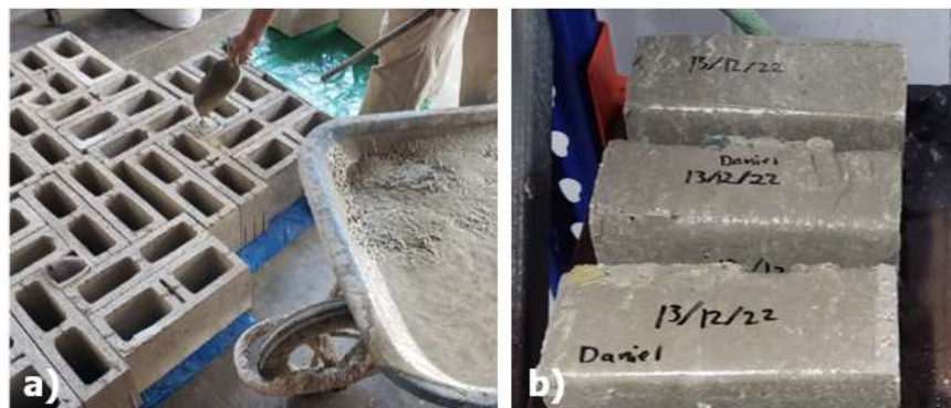
Figura 13. Especímenes de concreto de relleno: a) Elaboración de los prismas de concreto de relleno y b) Prismas de concreto relleno desmoldados.
