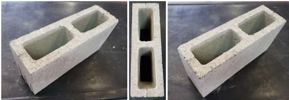
Figura 10. Bloque de concreto tradicional utilizado
