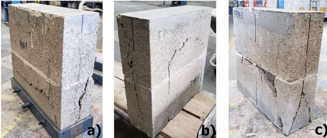
Figura 28. Modos de falla típicos de los prismas rellenos: a) falla por separación de la pared externa, b) falla de cortante y c) falla de cono y grieta vertical
