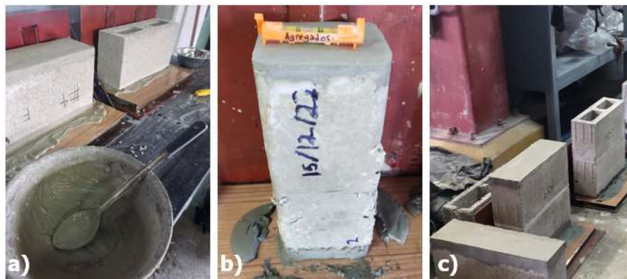
Figura 16. Coronamiento de los diferentes elementos: a) Coronamiento de los bloques, b) Coronamiento de los prismas de concreto de relleno y c) Coronamiento de los prismas de mampostería
