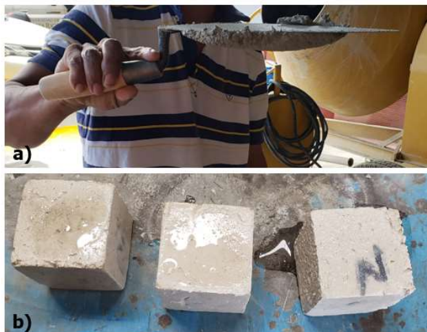
Figura 11. Fabricación del mortero de pega: a) Plasticidad adecuada de la mezcla y b) Cubos de mortero de 50x50 mm.
