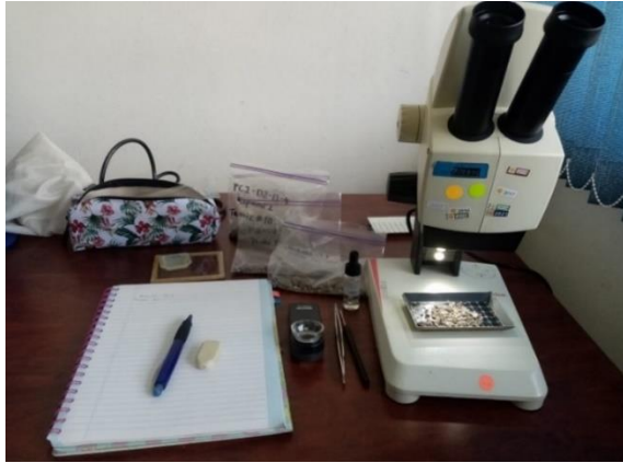
Figura 13. Proceso de análisis de clastos menores a 9.5 mm utilizando estereoscopia.
