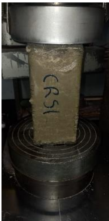
Figura 26. Prueba de compresión en el prisma de concreto de relleno CRS1
