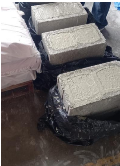
Figura 11. Prismas de mampostería rellenos
