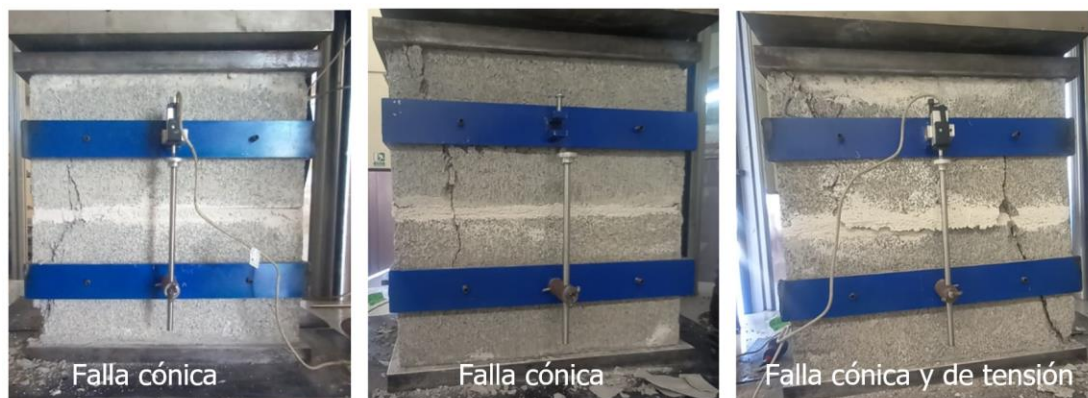
Figura 29. Modos de falla característicos en la cara frontal de los prismas
