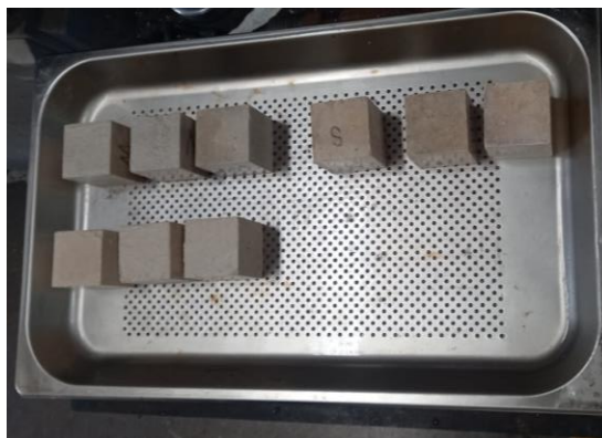
Figura 23. Cubos de mortero
