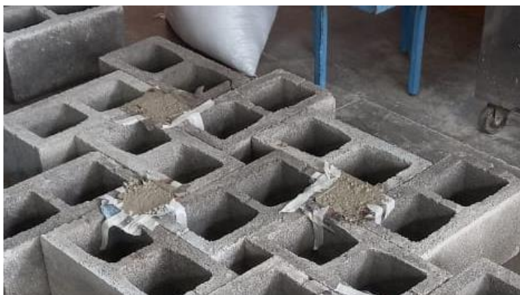
Figura 12. Prismas de concreto de relleno
