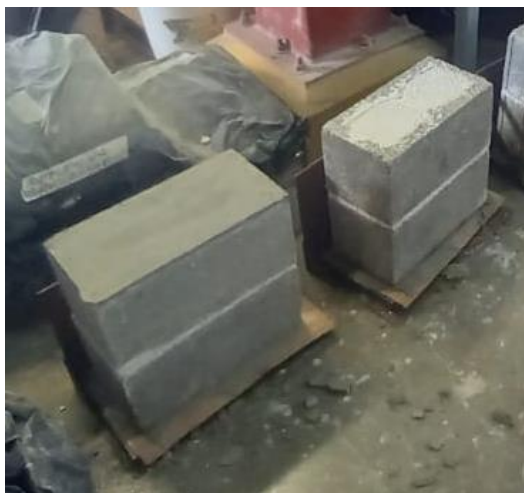
Figura 14. Coronamiento de prismas
