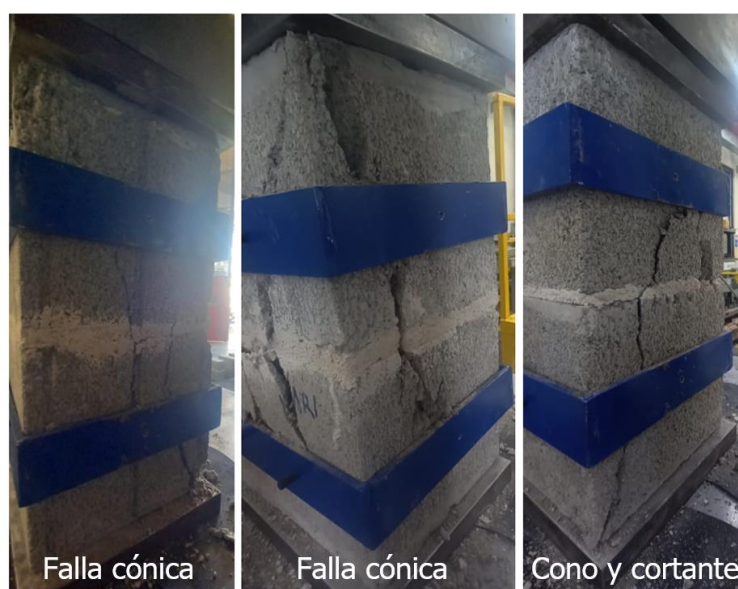
Figura 30. Modos de falla característicos en la cara lateral de los prismas
