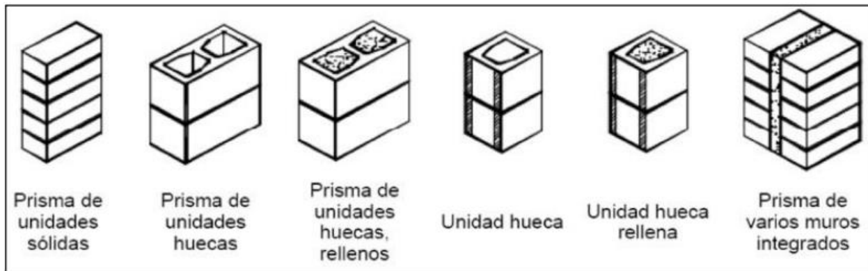
Figura 2-1. Elaboración de prismas de mampostería. Fuente: (INTE C55, 2015)
