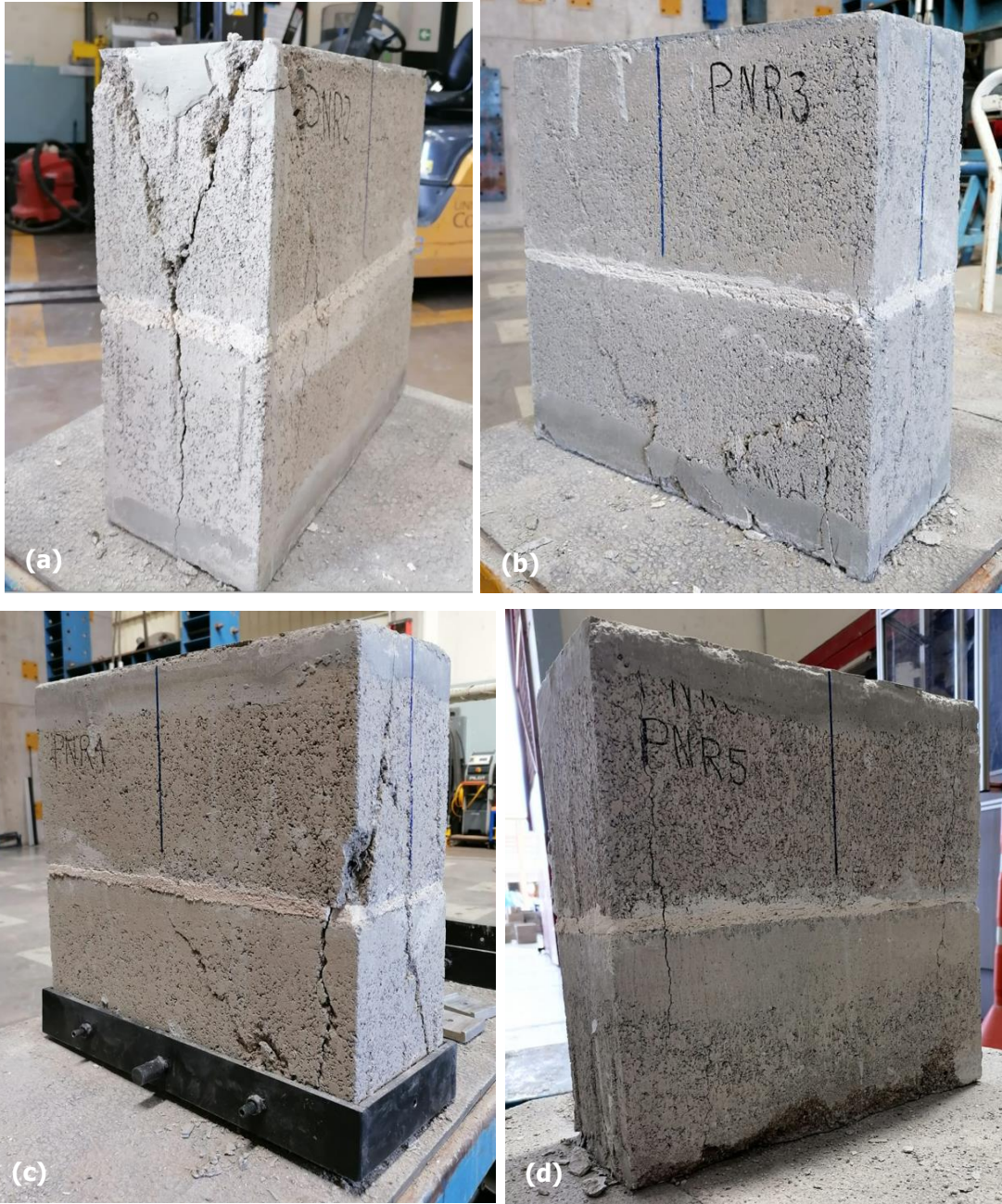
Figura 9-29. Modos de falla de los prismas de mampostería con mortero tipo N: (a) PNR2, (b) PNR3, (c) PNR4 y (d) PNR5.
