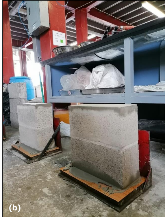
Figura 3-10. Coronamiento de los especímenes de ensayo: (a) Vista superior de los prismas de mampostería con su debido coronamiento y (b) Montaje empleado en el proceso de coronamiento.
