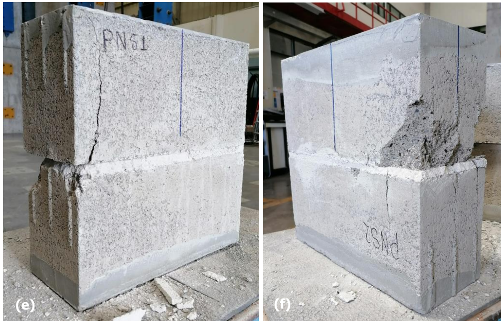
Figura 9-30. Modos de falla de los prismas de mampostería con mortero tipo N: (e) PNS1, (f) PNS2 (cont).
