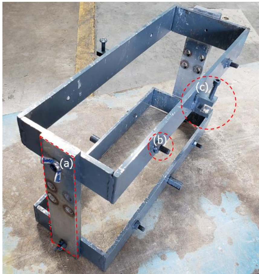
Figura 4-2. Diseño del aditamento empleado en el estudio: (a) Placa removible utilizada para asegurar la longitud de control, (b) Tornillos de fijación y (c) Pieza para sujetar el LVDT.
