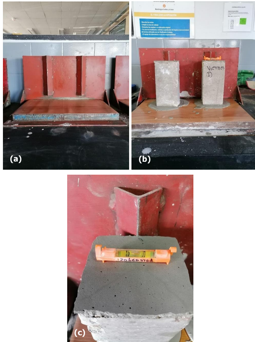
Figura 3-9. Proceso de coronamiento de los prismas de concreto de relleno: (a) Equipo utilizado para el coronamiento, (b) Vista frontal de los especímenes y (c) Corroboración del nivel en los especímenes.
