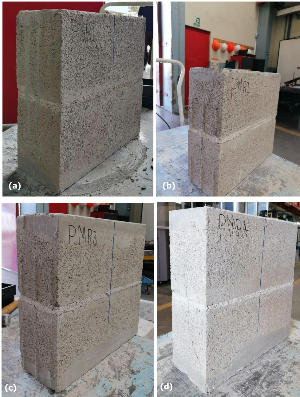
Figura 9-25. Modos de falla de los prismas de mampostería con mortero tipo M: (a) PMR1, (b) PMR2, (c) PMR3 y (d) PMR4.
