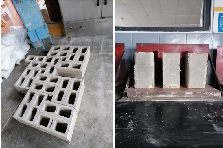
Figura 3-6. Prismas de concreto de relleno: (a) Arreglo usado en la fabricación de los prismas y (b) Prismas de concreto de relleno desmoldados.
