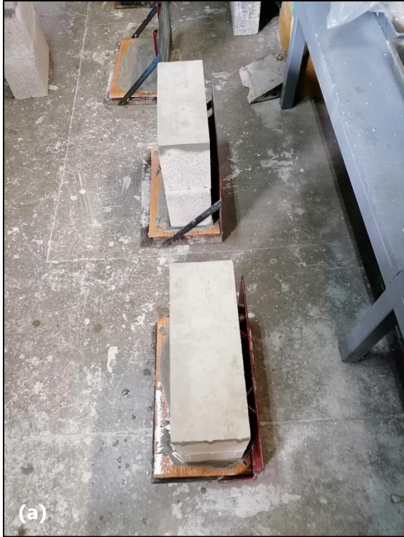
Figura 3-10. Coronamiento de los especímenes de ensayo: (a) Vista superior de los prismas de mampostería con su debido coronamiento y (b) Montaje empleado en el proceso de coronamiento.
