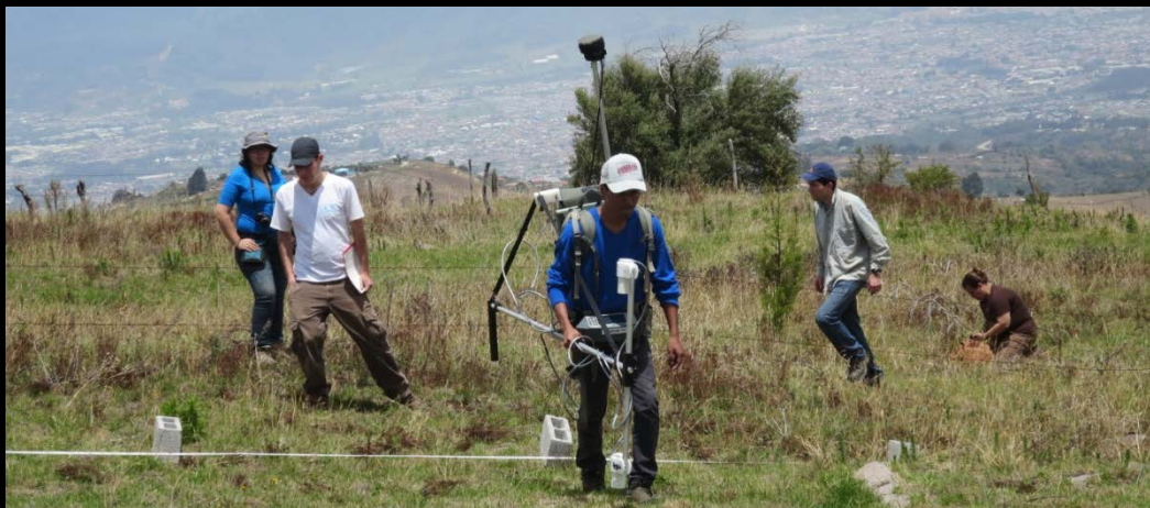
Prospección con el gradiómetro de cesio en el sitio Alto del Cardal (C-304-AC), año 2015.
