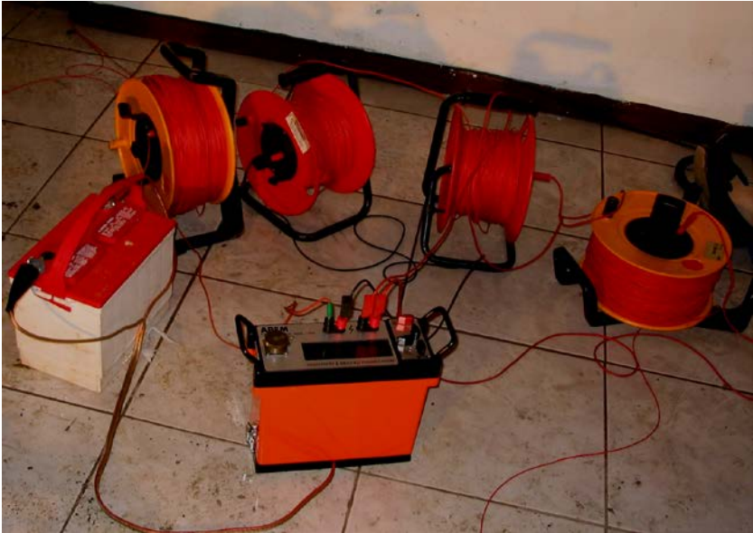
Figura 11: Equipo de resistividad eléctrica, marca ABEM, tipo Terrameter 1000. Consta de un emisor-receptor, cuatro bobinas de cable eléctrico, una batería y varios electrodos de emisión de corriente.
