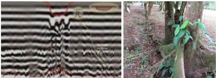
Figura 34: Radargrama realizado cerca de depresión y árbol, la imagen de la izquierda muestra hipérbolas generadas por el ruido de las ramas, en rojo se muestra la anomalía generada por la depresión.
