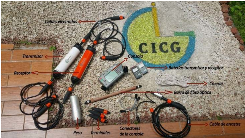
Figura 3: Esquema del arreglo y componentes del dispositivo OhmMapper.
