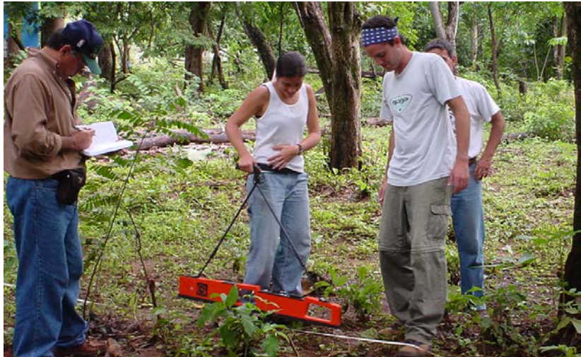
Figura 7. Equipo electromagnético EM-38. Foto tomada en Sámara con fines hidrogeológicos.
