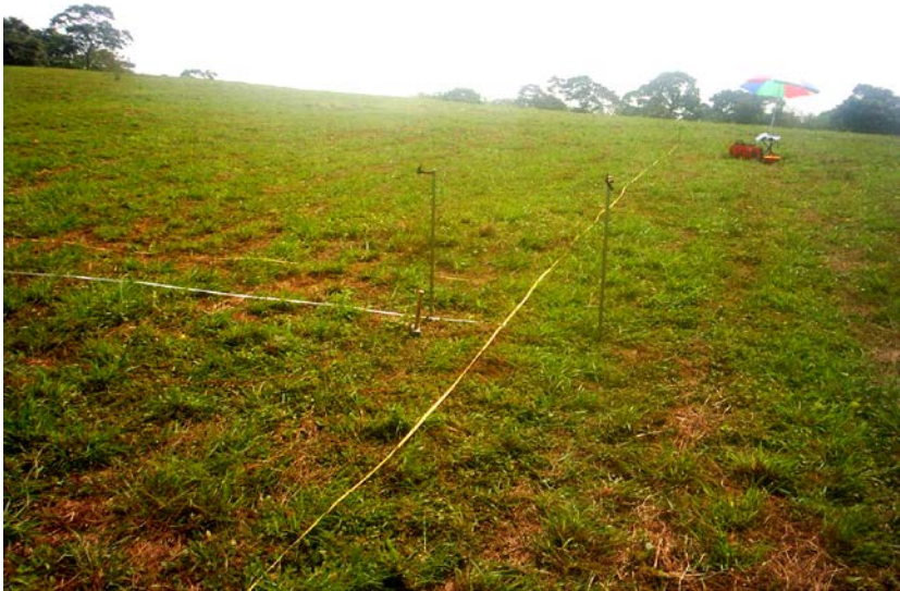
Figura 12: Detalle de la zona prospectada que fue delimitada con cintas métricas, obsérvese la localización de dos de los electrodos de medición en la configuración Polo-Polo.
