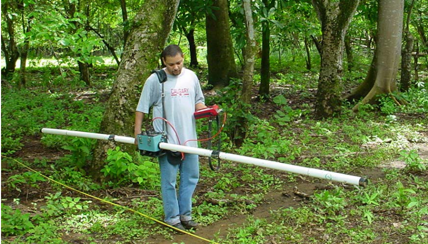
Figura 8. Equipo electromagnético EM-31. Foto tomada en Sámara con fines hidrogeológicos.
