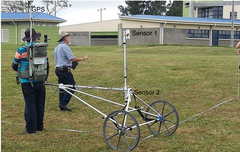
Figura 4: Gradiómetro de Cesio, con antena de posicionamiento global, montado sobre carreta para desplazarse en el campo
