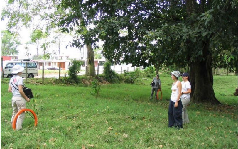
Figura 6. Equipo electromagnético EM-34, utilizado en el sitio Agua Caliente, 2003.
