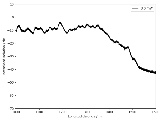
(c) Distribución espectral por longitud de onda en el IR para 3,0 mW como referencia.
