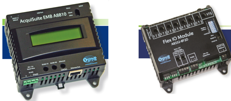
Figura 4.11: A la izquierda, servidor de adquisición de datos OBVIUS. A la derecha, módulo convertidor de señal analógica a digital que admite hasta 8 entradas de señal analógica[40].
