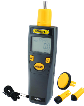
Figura 4.12: Tacómetro marca General para medir la velocidad de rotación del impulsor[24]
