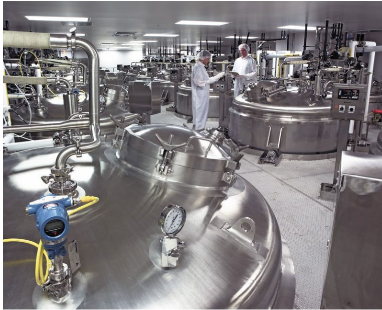
Figura 15.6: Bioreactores de producción industrial. La industria de inmunobiológicos basados en anticuerpos monoclonales terapéuticos representa un vasto mercado mundial para las empresas farmacéuticas. Foto: Lonza Group, Ltd.
