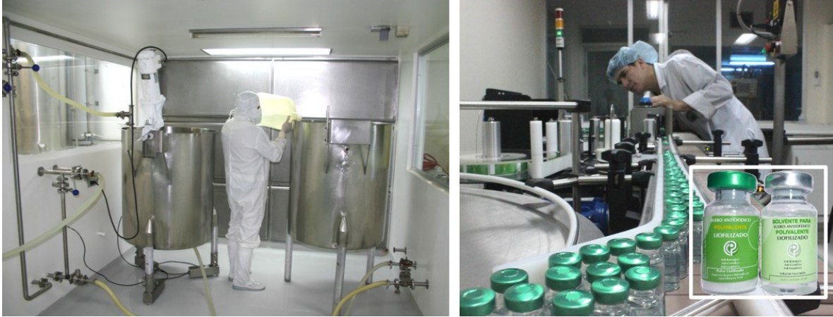
Figura 3.5: Procesamiento de plasma equino hiperinmune por precipitación con ácido caprílico en tanques industriales, para la producción de antivenenos terapéuticos ("sueros" antiofídicos). Las imágenes corresponden al proceso que se lleva a cabo en la División Industrial del Instituto Clodomiro Picado (Universidad de Costa Rica) para elaborar diversos tipos de antivenenos usados en la terapia del envenenamiento por mordeduras de serpientes. Fotos: Instituto Clodomiro Picado.
