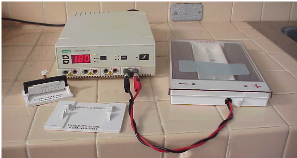
Figura 11.2: Fuente de poder y cámara para electroforesis en poliacetato de celulosa. La fuente de poder (izquierda) se conecta a los electrodos de la cámara (derecha), observando la polaridad correcta. La cámara tiene una tapa acrílica transparente que permite visualizar la corrida de las muestras, a la vez que previene accidentes por descargas eléctricas. Foto del autor.
