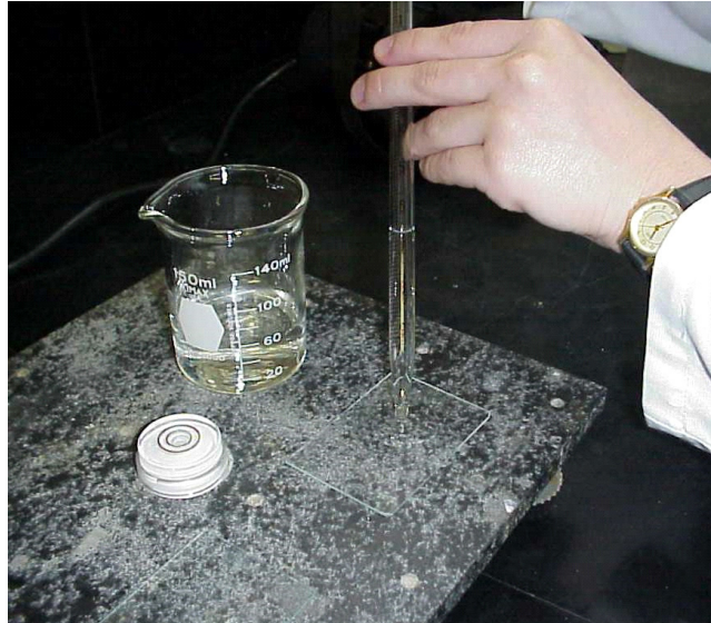
Figura 5.3: Preparación de un gel de agarosa sobre una lámina de vidrio. Se pipetea el volumen requerido de solución de agarosa caliente, y se esparce rápidamente sobre toda la superficie de una placa de vidrio, con cuidado de que no rebase los bordes y sin atrapar burbujas. La placa debe estar sobre una superficie ajustable y nivelada (observe el indicador de nivel, a la izquierda), para asegurar que el grosor final del gel sea uniforme. Una vez esparcida la solución, se deja en reposo por unos minutos hasta que gelifique. Foto del autor.
