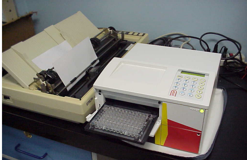
Figura 10.8: Lector automático de placas de 96 hoyos. Estos espectrofotómetros utilizan un sistema de haces de luz múltiples, perpendiculares a la placa, que permiten leer la absorbancia de los 96 hoyos en menos de 10 segundos. Las lecturas pueden ser enviadas a una unidad de almacenamiento tipo USB, o transferidas directamente a una computadora, en donde pueden procesarse los datos. Los lectores poseen un conjunto de filtros para seleccionar la longitud de onda apropiada a cada tipo de sustrato, y son útiles en muy diversas técnicas, además del ELISA. Foto del autor.
