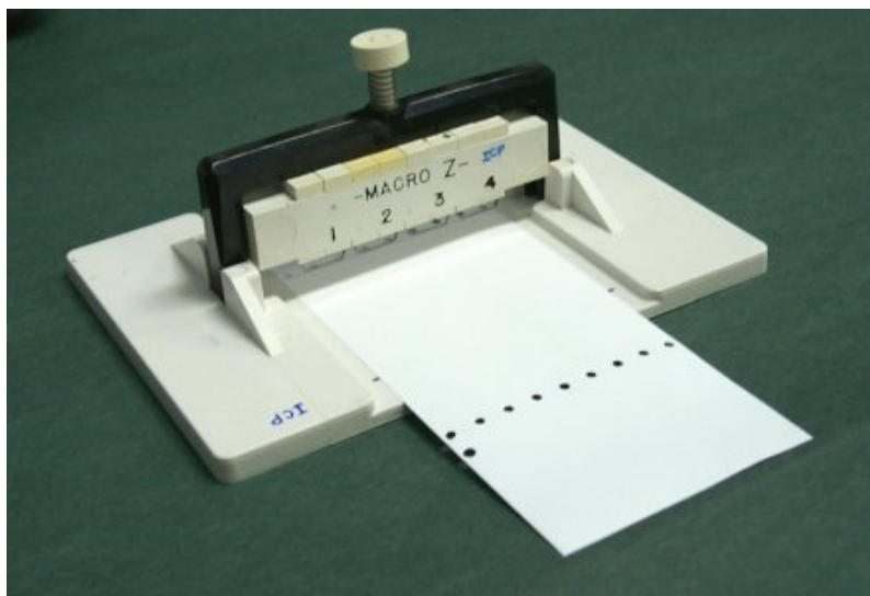
Figura 11.6: Aplicador de muestras para electroforesis en cintas de poliacetato de celulosa. Las muestras se colocan en un cargador con alambres que atrapan 2-3 \mu l, mediante capilaridad. Luego, el cargador se presiona suavemente sobre la cinta prehidratada, dejando marcadas las muestras por contacto, sobre su superficie. Foto del autor.
