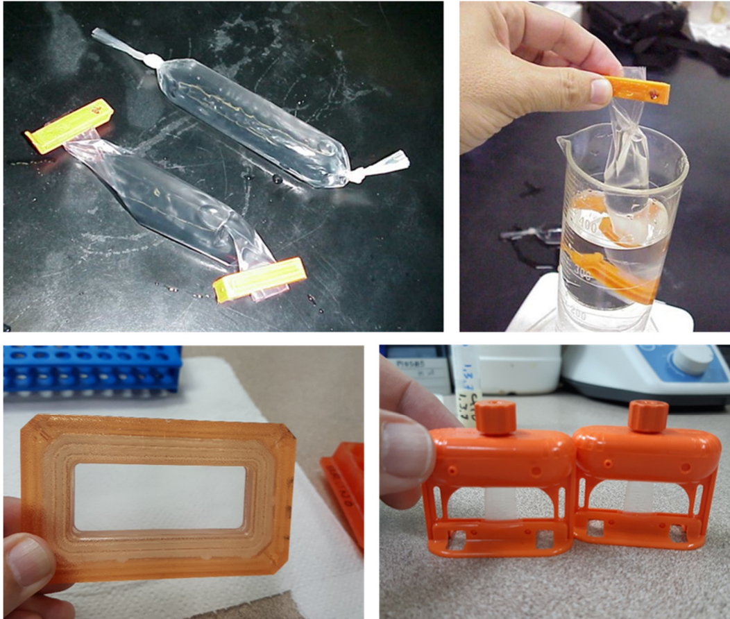
Figura 3.1: Diálisis . Arriba: Las bolsas o membranas de diálisis secas se hidratan en agua destilada y se llenan con la solución proteica, de la cual se va a eliminar las sales y otros pequeños solutos. La selección del tamaño nominal del poro, dado por el fabricante (ej. 3.500 daltons, 12.000 daltons, etc.) debe asegurar que la proteína de interés no escape de la bolsa junto con los solutos. Las bolsas se sellan en sus extremos mediante prensas especiales, o alternatively, haciendo nudos (con cuidado de no tensar excesivamente la región de la membrana que participa en la diálisis, para no alterar mecánicamente el tamaño de los poros). Finalmente se sumerge la bolsa de diálisis en el solvente final deseado (agua destilada, PBS, etc.) y se deja difundir pasivamente los solutos, manteniendo una agitación suave y realizando varios cambios del solvente, preferiblemente a 4°C. Abajo: también se dispone de aditamentos comerciales en forma de un "cassete" con membranas laterales (izquierda) que se llenan usando una jeringa que atraviesa un sello de silicón en sus esquinas, y luego se ponen a flotar. Incluso para volúmenes muy pequeños (ej. 0,5 ml) existen aditamentos que poseen membranas selladas en la parte inferior, y una entrada sellada con rosca en la parte superior. Una ventaja de la diálisis sobre otros métodos es su simplicidad. Su desventaja radica en que es un proceso lento (pasivo), que puede requerir 24 hr o más dependiendo de las condiciones. Fotos del autor.
