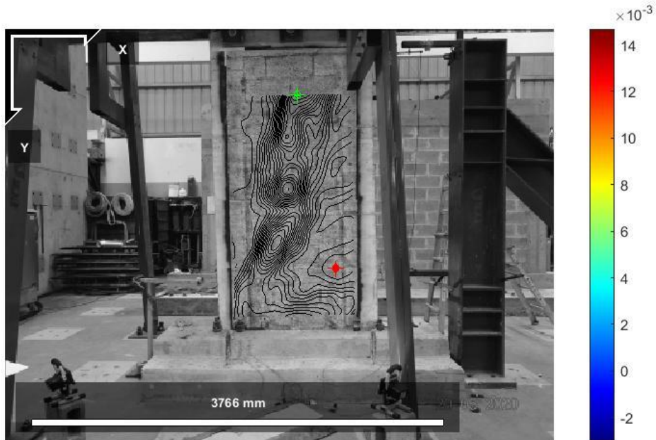
Imagen 106. Líneas de contornos de las deformaciones \epsilon_{yy} sobre la imagen 700, con la ubicación de los valores máximos y mínimos. Escala en milímetros. Ncorr, Matlab.
