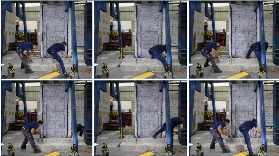
Imagen 59. Ajustes realizados a los pernos que anclan el muro al piso fuerte, suscitados durante la falla. Lanamme-UCR.
