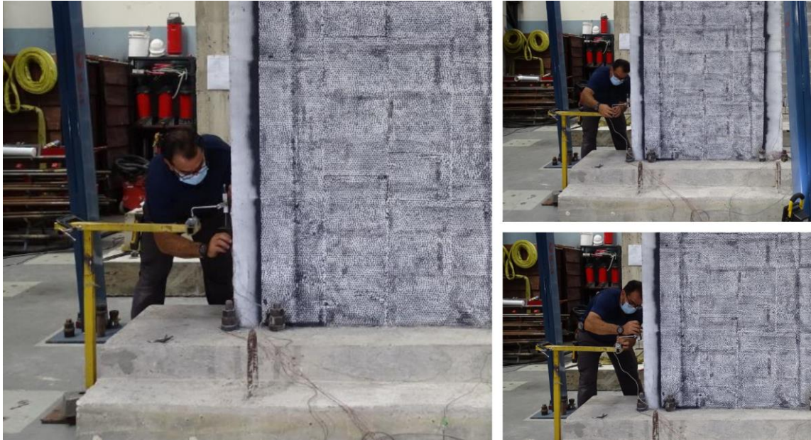
Imagen 58. Ajuste del transformador diferencial de variación lineal 1 (LVDT 1), debido a una posible descalibración del instrumento.
