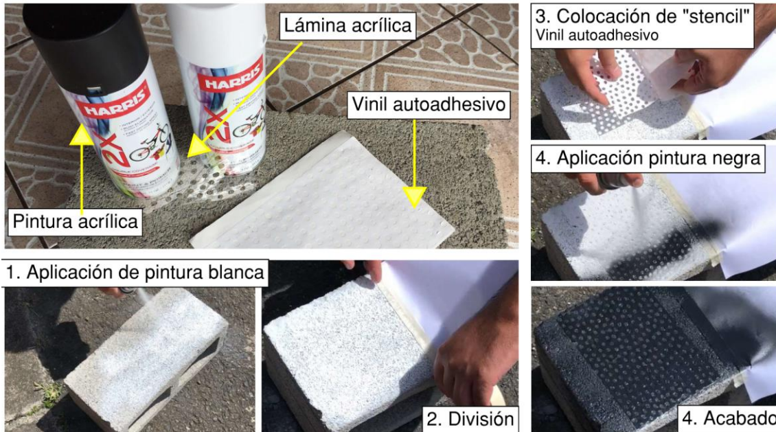
Imagen 50. Procedimiento experimental para la plantilla o stencil fabricada en vinil autoadhesivo.
