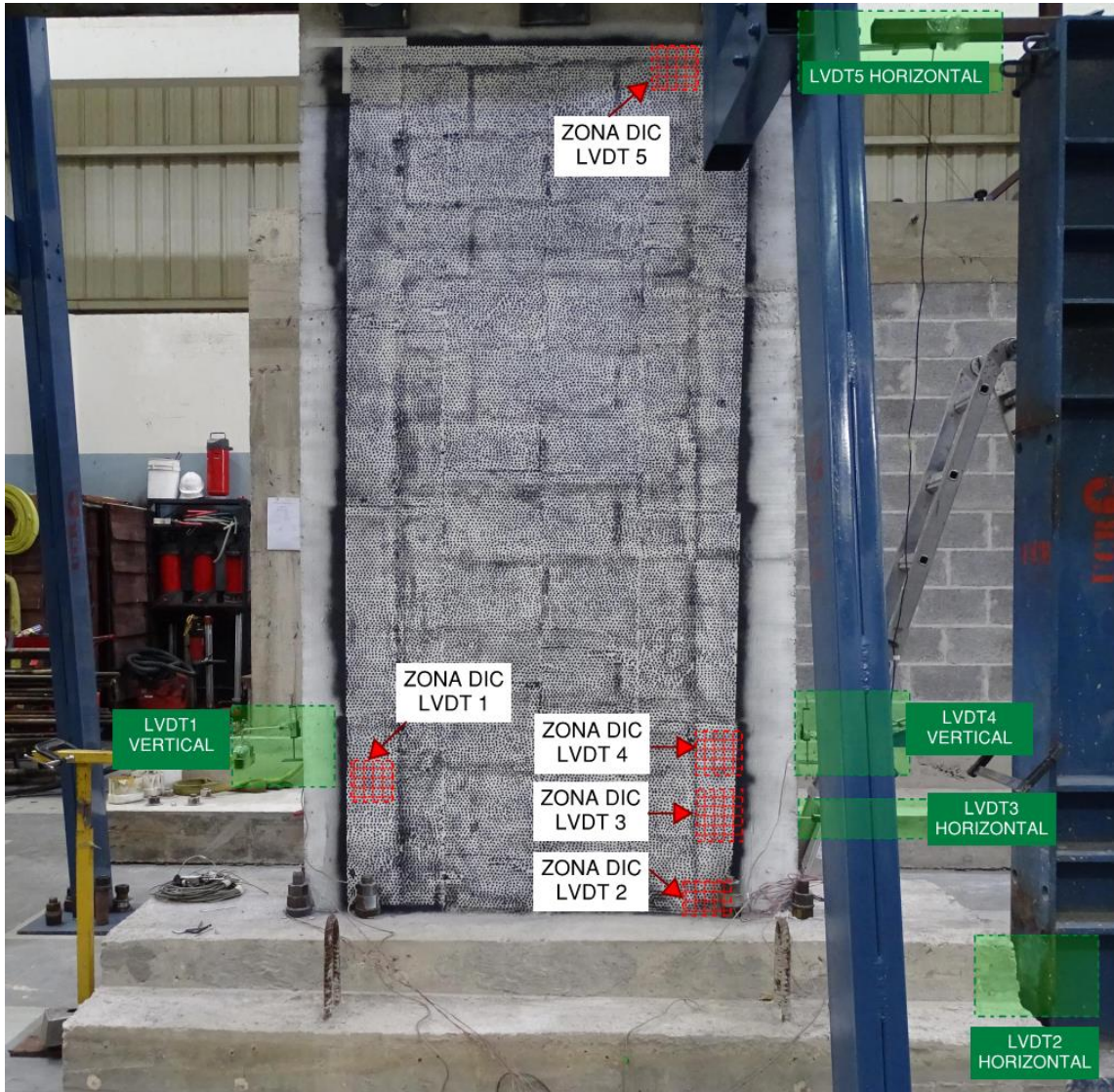
Imagen 60. Región de interés o Zonas DIC LVDT n para cada medición. Lanamme-UCR.
