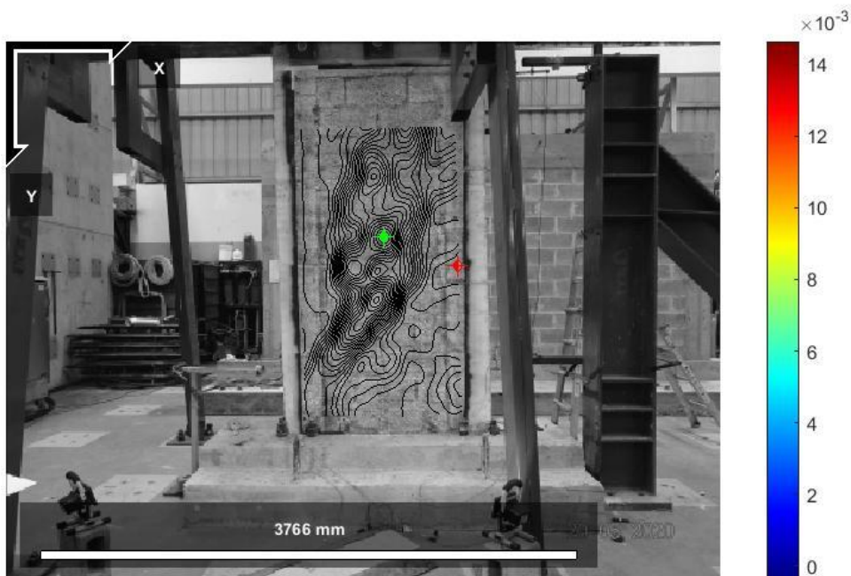
Imagen 105. Líneas de contornos de las deformaciones \epsilon_{xx} sobre la imagen 700, con la ubicación de los valores máximos y mínimos. Escala en milímetros. Ncorr, Matlab.
