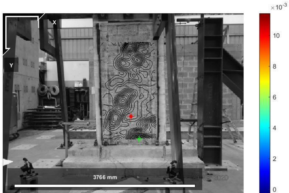
Imagen 106. Líneas de contornos de las deformaciones \epsilon_{yy} sobre la imagen 700, con la ubicación de los valores máximos y mínimos. Escala en milímetros. Ncorr, Matlab.
