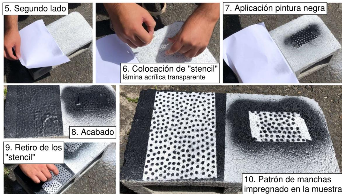
Imagen 51. Procedimiento experimental para la plantilla o stencil fabricada lámina acrílica transparente.
