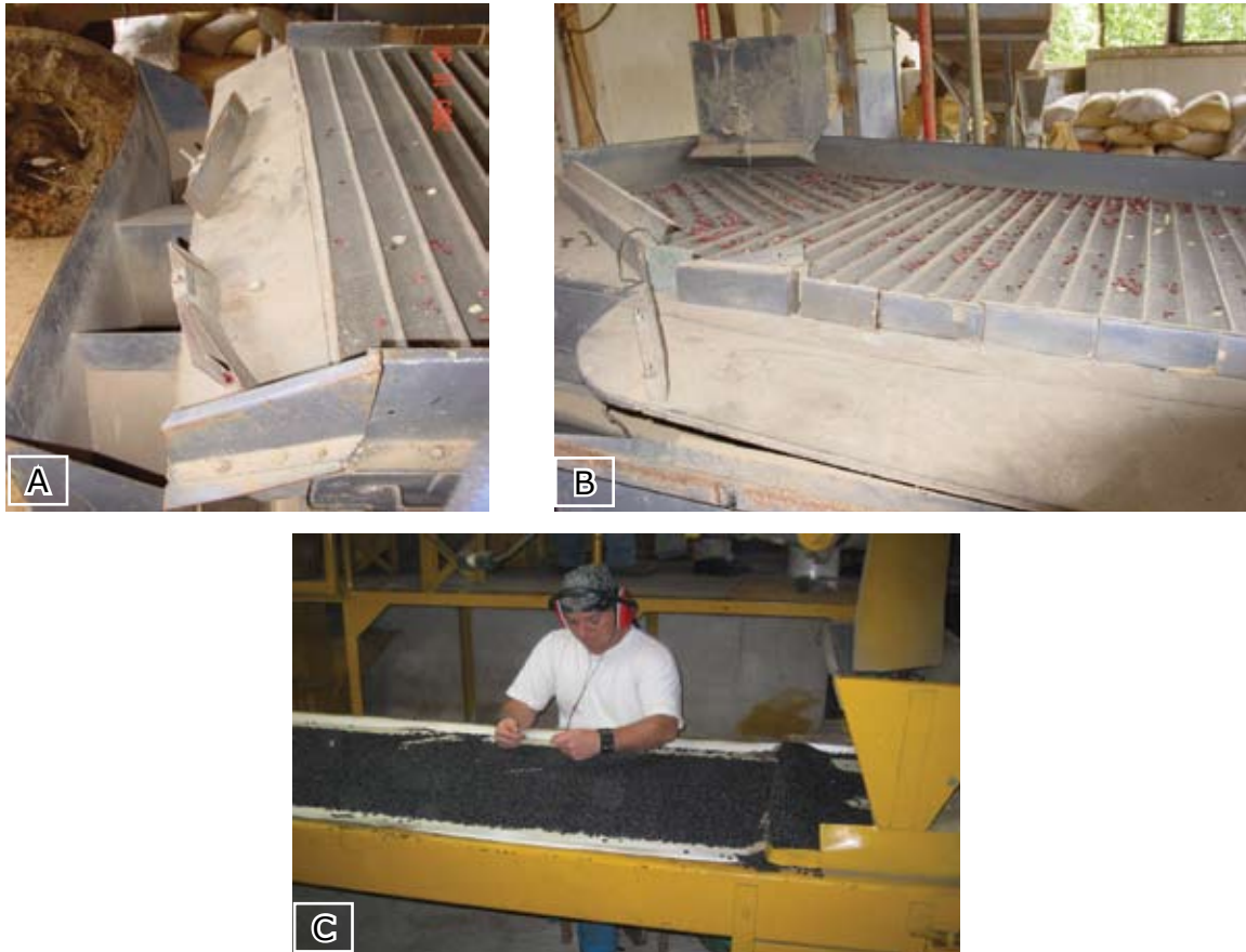
Figura 14. Clasificadora de frijol (A y B) y clasificación final manual de la semilla de frijol (C).
