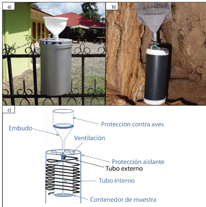
Fig. 7. Colectores de agua en a) se observa el colector de agua de lluvia (coordenadas 415887/1167099), en b) el colector de agua de infiltración dentro de la cueva en el sector Sala 1 y en c) un diagrama esquemático, modificado de Gröning et al. (2012), sobre la construcción de ambos.
