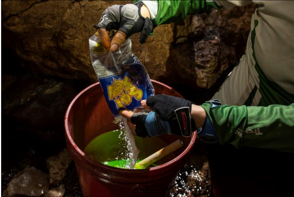
Fig. 10. Adición de sal de mesa al agua de la caverna. Fotografía cortesía de A. Brenes.
