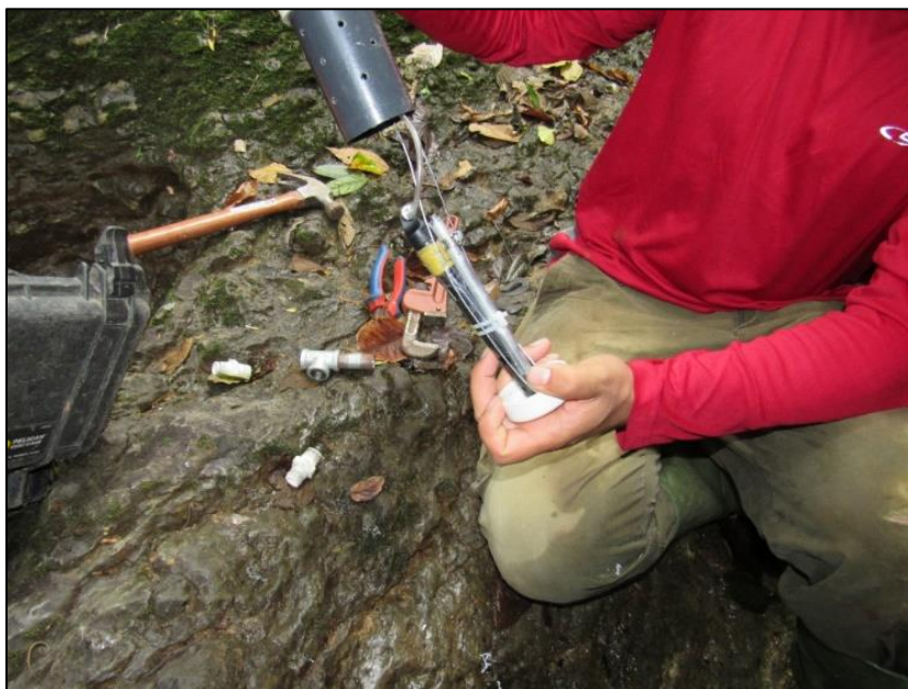
Fig. 6. Data logger instalado en la quebrada El Túnel (coordenadas 415990/1167317) para el monitoreo del nivel y temperatura del agua.
