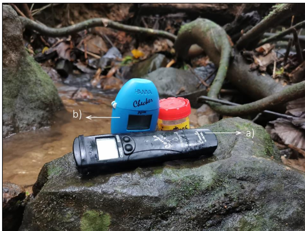
Fig. 9. Instrumentos utilizados para la medición de parámetros in situ a) multiparamétrico (T, C.E y pH) de bolsillo b) colorímetro de alcalinidad.
