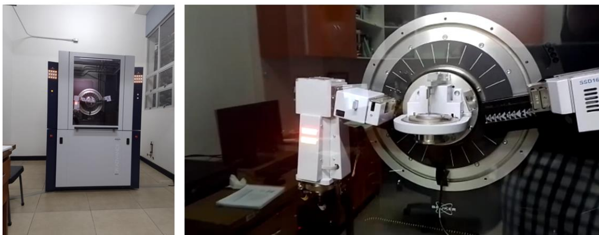
Figura 4.2. Equipo Bruker modelo D8 ADVANCE ECO, en la Unidad de Difracción de Rayos X de la Escuela de Química de la Universidad de Costa Rica.
