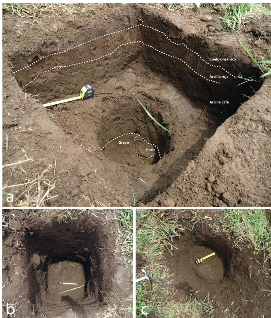
Fig. A1.4: Pozos de sondeo: a) vista de las diferentes capas de materiales diferenciados en el pozo 1; b) vista del pozo 2; vista del pozo 4. En todas las imágenes se observan bloques (ígneos) redondeados al fondo.
