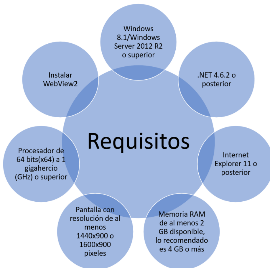
Figura 8. Requisitos técnicos para instalar Power BI desktop
